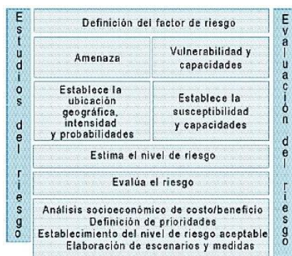
Figura 80 Etapas del proceso de evaluación del riesgo
