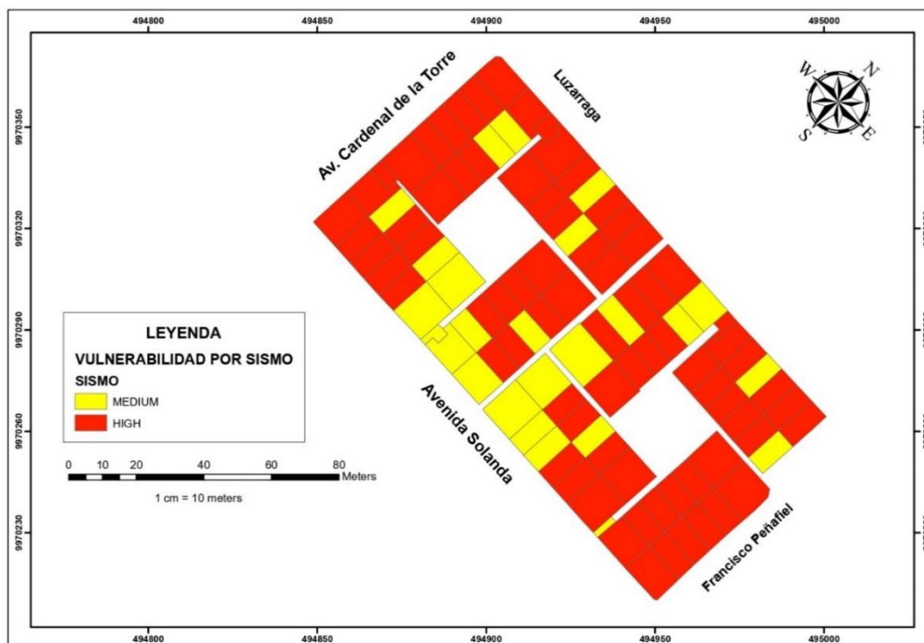
Figura 72 Vulnerabilidad por sismo MZ A
