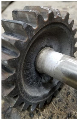
Figura 2.44. Eje antiguo con cambio de sección.
