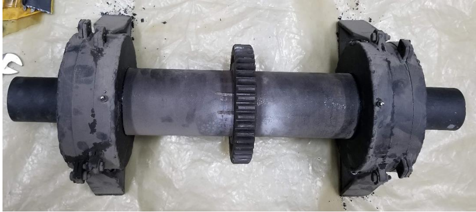
Figura 2.40. Estado inicial del Molde de la máquina de colado centrífugo horizontal.
