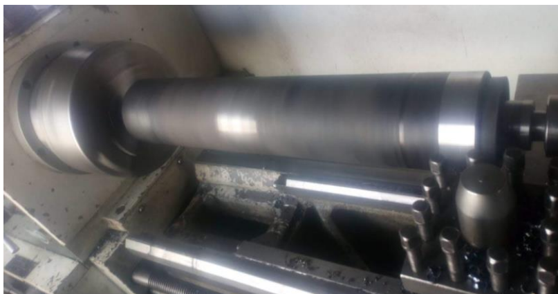
Figura 2.41. Torneado del molde de la máquina de colado centrífugo horizontal.
