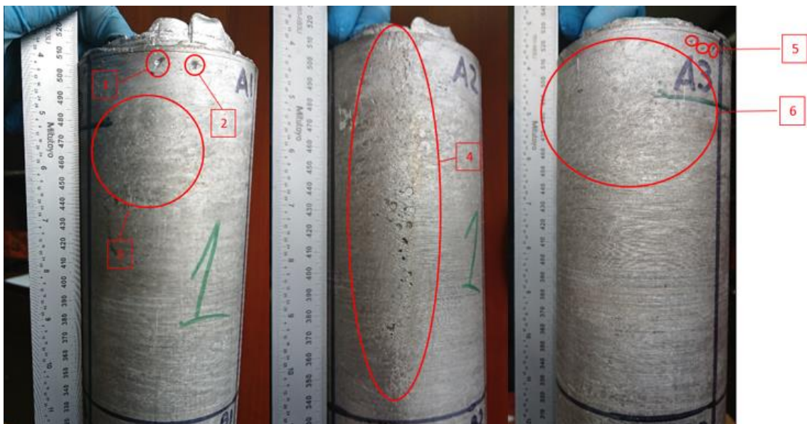
Figura 3.3. Inspección visual de la sección A de la tubería P1.
