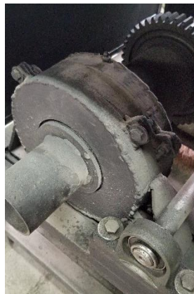
Figura 2.7. Apoyo del molde en chumaceras.
