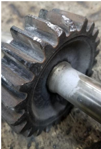
Figura 2.2. Engrane con falla por fatiga.
