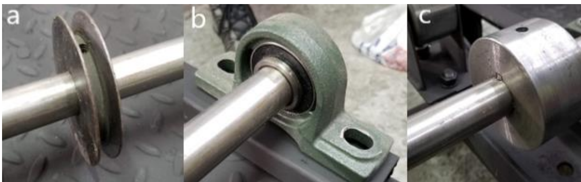
Figura 2.45. Elementos anclados al eje. a) Polea menor, b) Chumaceras y c) Rodetes conducidos.
