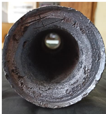
Figura 3.2. Superficie interior de la tubería obtenida por colado centrifugo.
