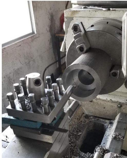
Figura 2.42. Proceso de cilindrado interno para obtención de pistas del molde.
