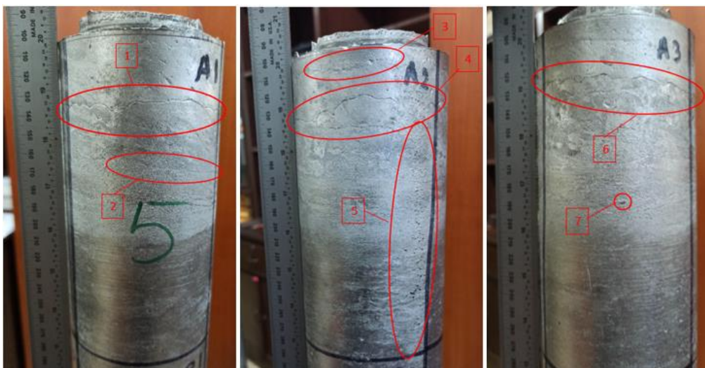
Figura 3.9. Inspección visual de la sección A de la tubería P5.
