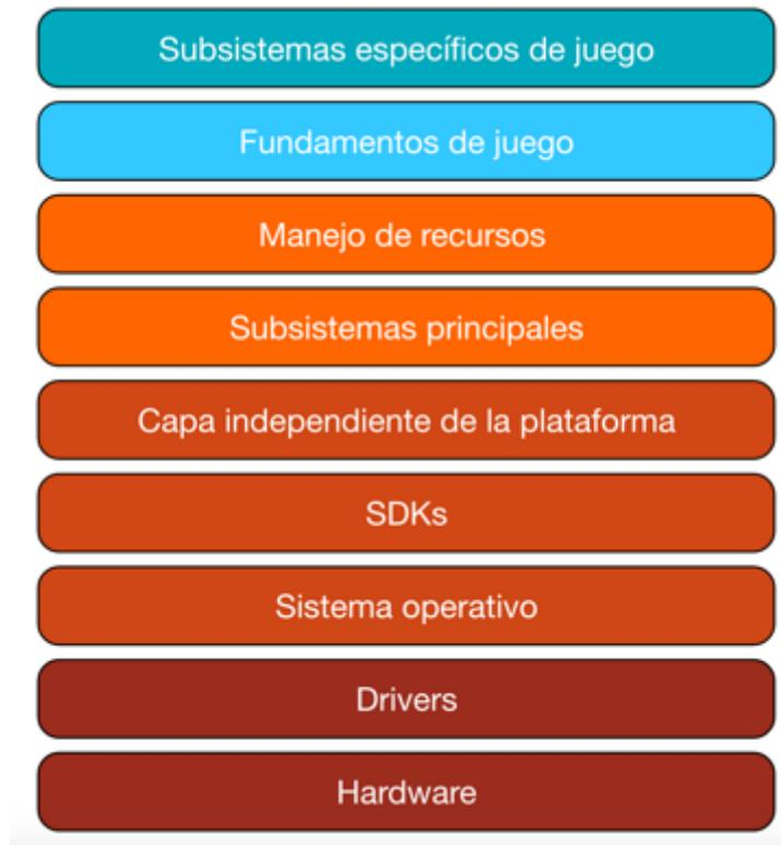
Figura 4. Arquitectura en capas de un motor de juegos
