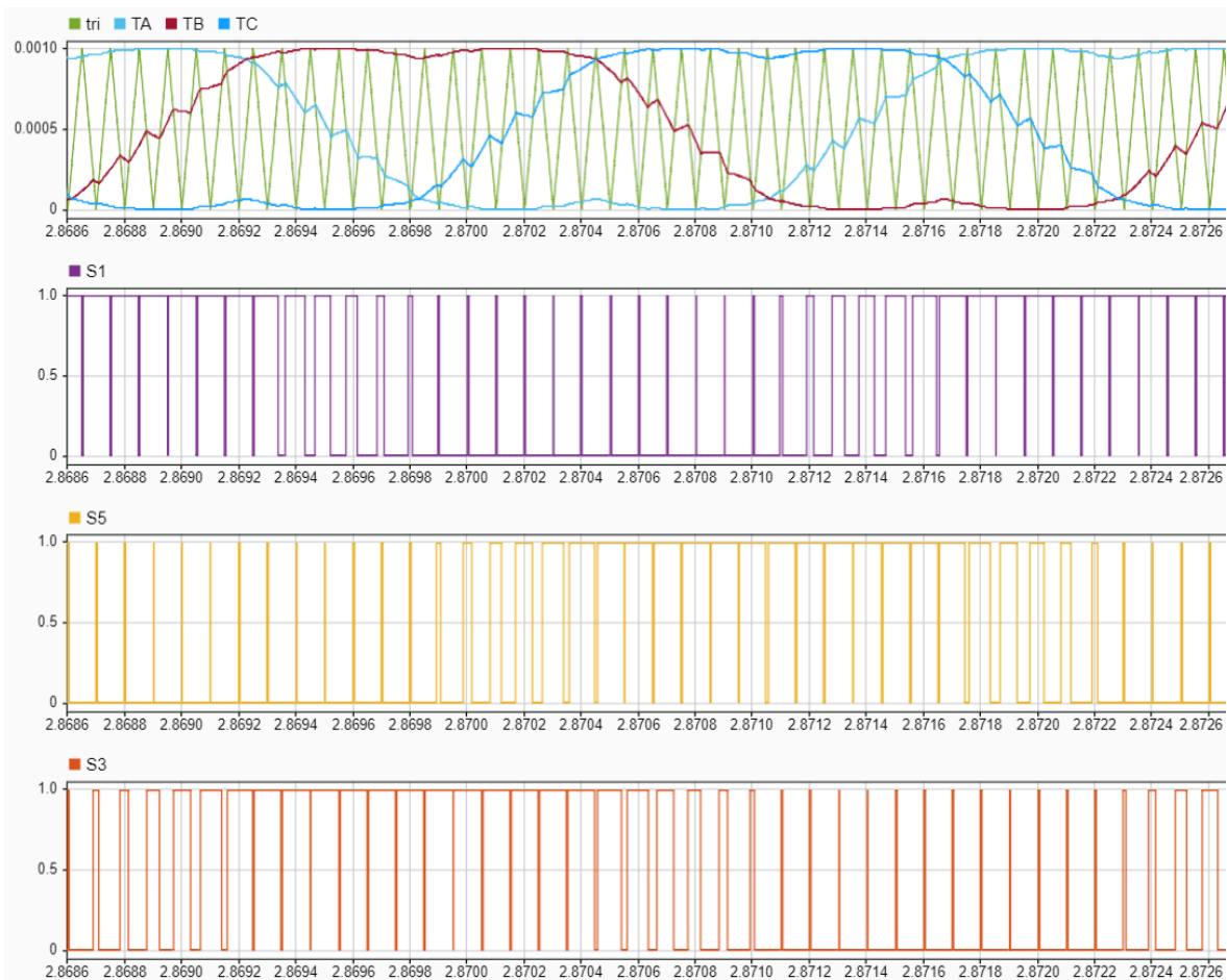
Figura 2.28. Señales TA, Tb y TC comparadas con una señal triangular.
