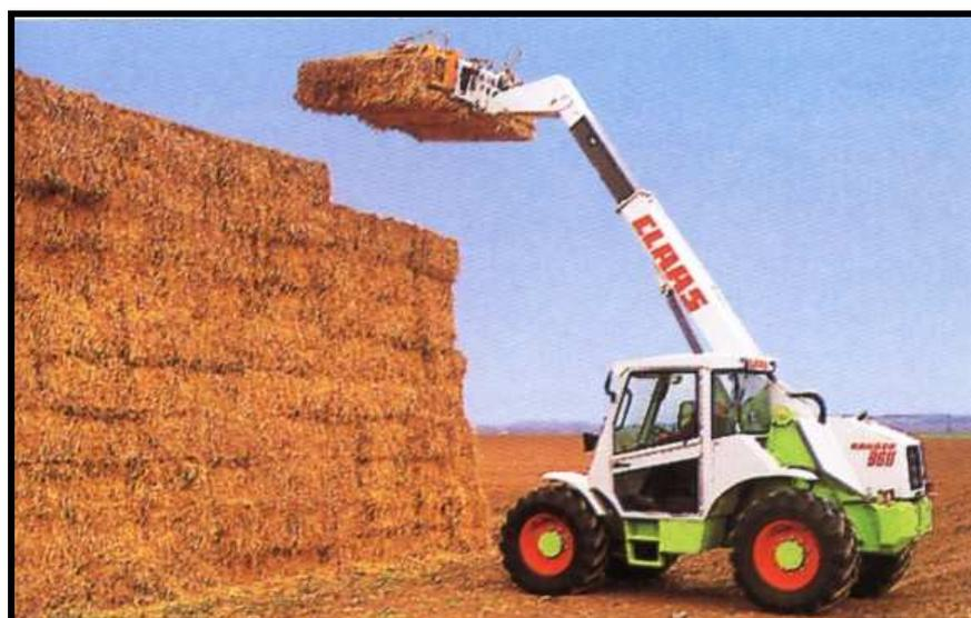
**Figura 1.6:** Elevador Mecánico para el Almiar
