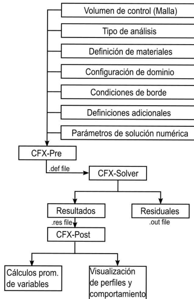
Figura 29. Desarrollo de CFX para simulación de tanque (fuente: Gil, 2020)
