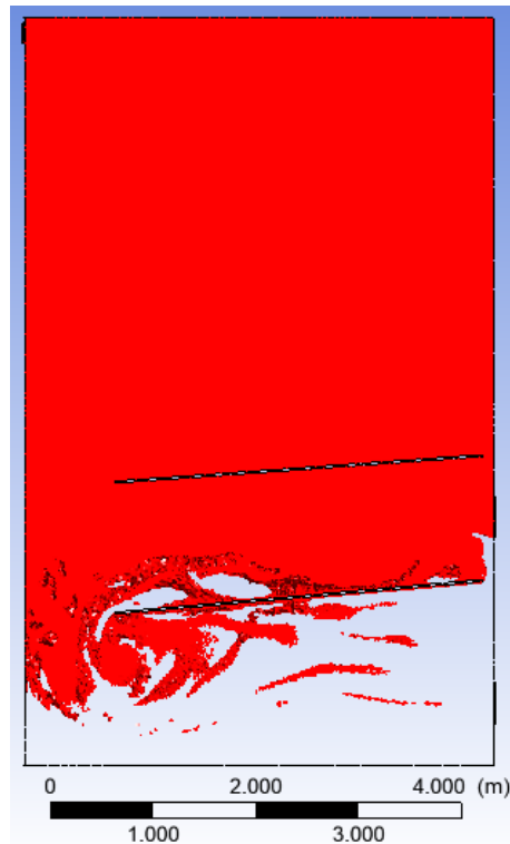
Figura 49. Isovolumen de petróleo en simulación 3D (Fuente: Gil, 2020)
