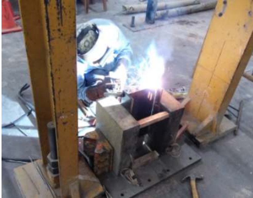
Figura No. 3. 33: Conformación de las probetas push out Elaborado: Jonathan Franco & Miguel Martínez
