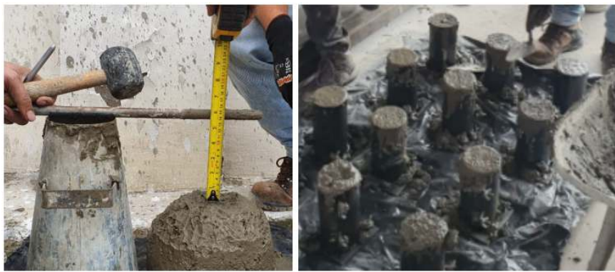
Figura No. 3. 30: Ensayo del cono de Abrams y cilindros para ensayos a compresión Elaborado: Jonathan Franco & Miguel Martínez
