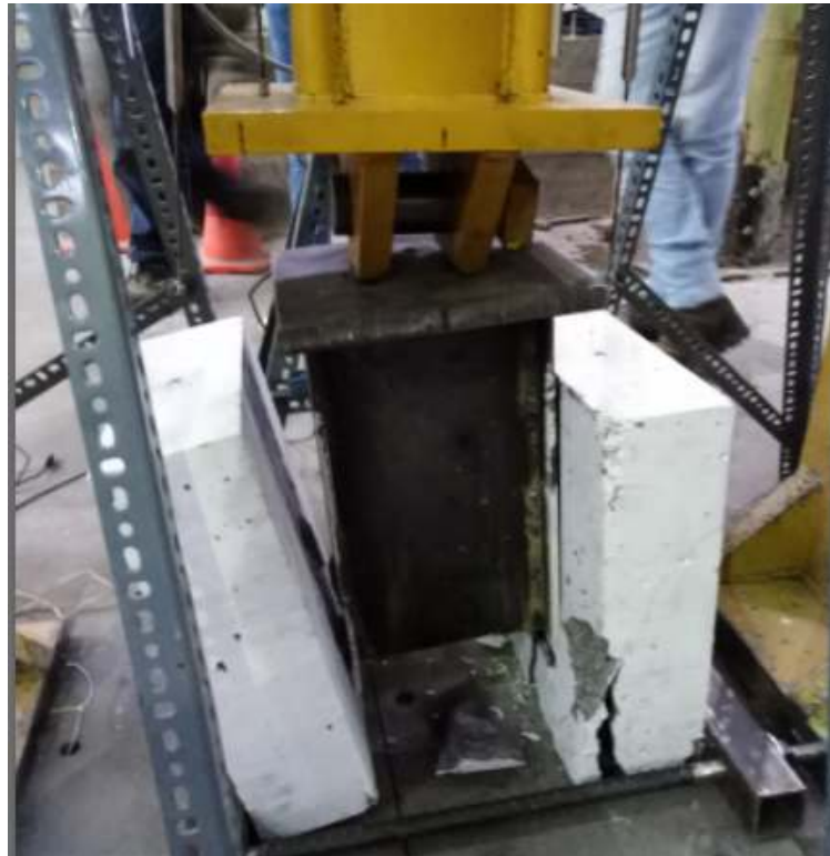
Figura No.4.20: Esquema general 1 de falla de las probetas push-out Elaborado: Franco Jonathan & Martínez Miguel
