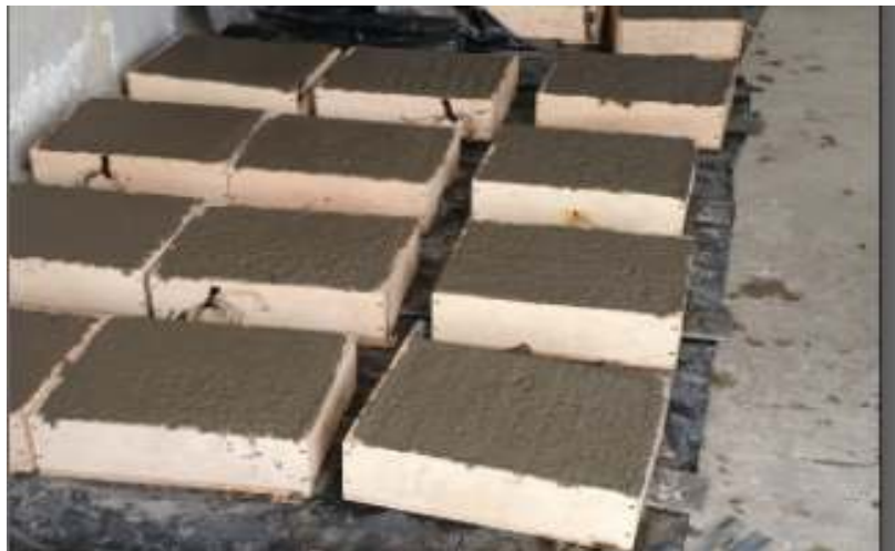
Figura No. 3. 31: Losas para la conformación de las probetas push-out Elaborado: Jonathan Franco & Miguel Martínez
