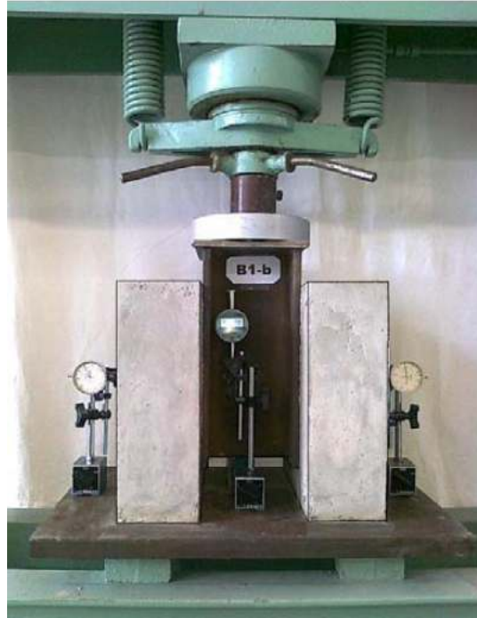
Figura No. 3. 26: Instrumentación de una probeta para ensayo de push-out.
