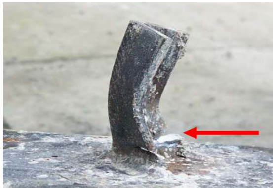
Figura No. 3. 15: Modos de falla del conector de corte tipo ángulo. Fuente: Chacón & Poveda, (2012)
