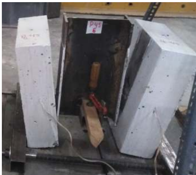
Figura No.4.21: Esquema general 2 de falla de las probetas push-out Elaborado: Franco Jonathan & Martínez Miguel
