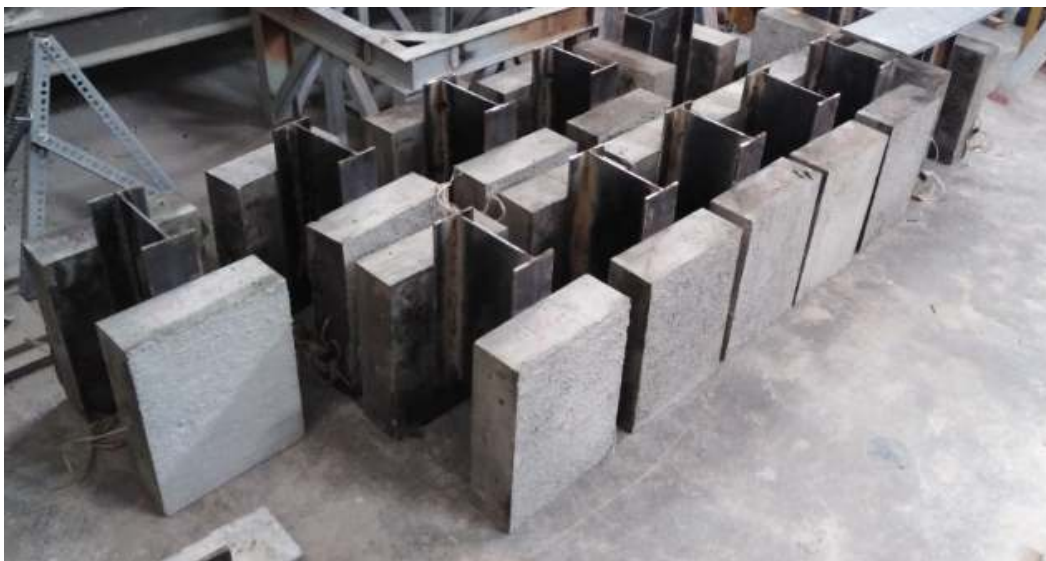
Figura No. 3. 34: Probetas push-out ensambladas Elaborado: Jonathan Franco & Miguel Martínez
