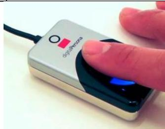
**Figura 2.18.** Escáner biométrico digital persona U.are.u 4500 [26]
