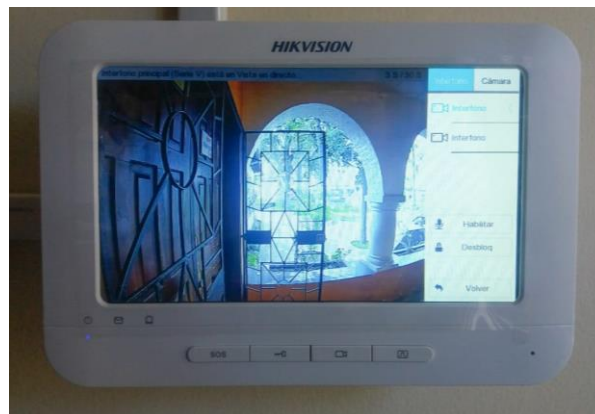
Figura 3.20: Prueba entre la placa externa y pantalla
