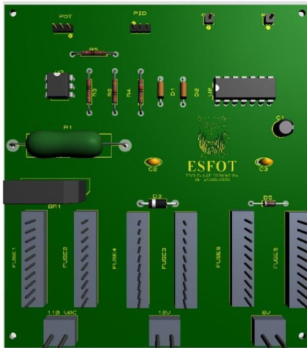
**Figura E-3** Prototipo Placa PWM vista frontal
