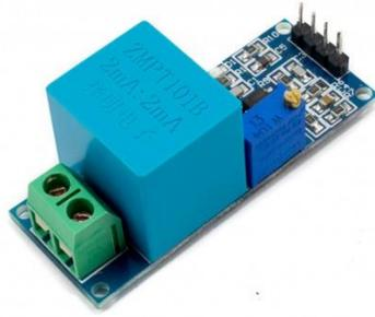
**Figura 3.28** Módulo transformador de voltaje AC
