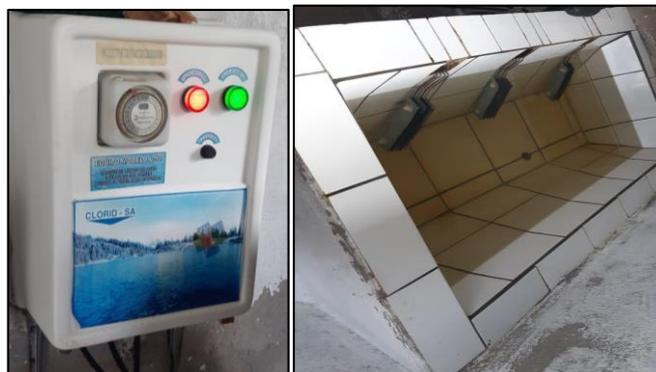
**Figura 31.** Equipo ecológico productor de hipoclorito de sodio, modelo L-90.
