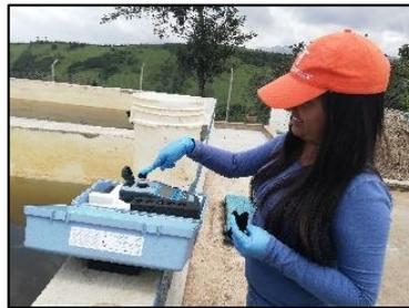
**Figura 8.** Turbidímetro.
