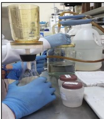
**Figura 11.** Filtración al vacío para la determinación de color real.
