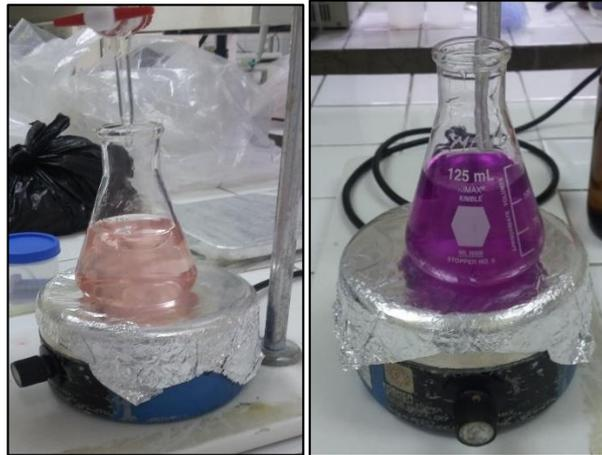
**Figura 16.** Análisis de dureza cálcica, cambio de color de rosa inicial a púrpura.
