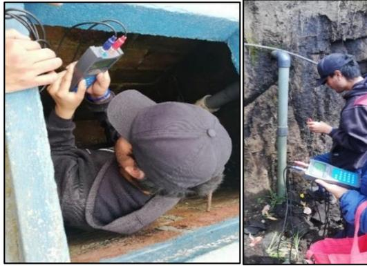
**Figura 38.** Medición con el caudalímetro ultrasónico.
