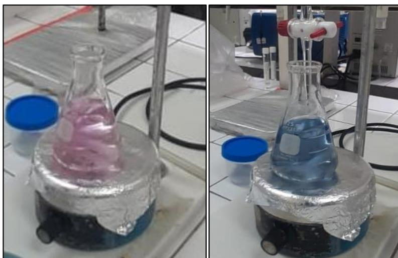
**Figura 17.** Análisis de dureza total, cambio de color de violeta a azul pálido.
