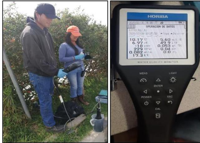
**Figura 7.** Equipo Medidor Portátil Multiparámetro.
