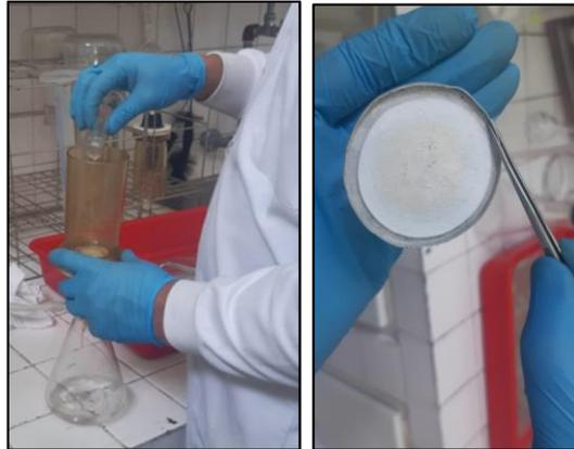
**Figura 13.** Filtración al vacío para sólidos suspendidos.
