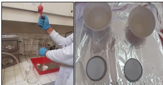
**Figura 12.** Llenado del crisol con la muestra filtrada.
