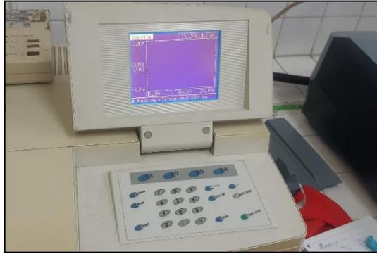
**Figura 22.** Determinación de la absorbancia de nitratos en el espectrofotómetro.
