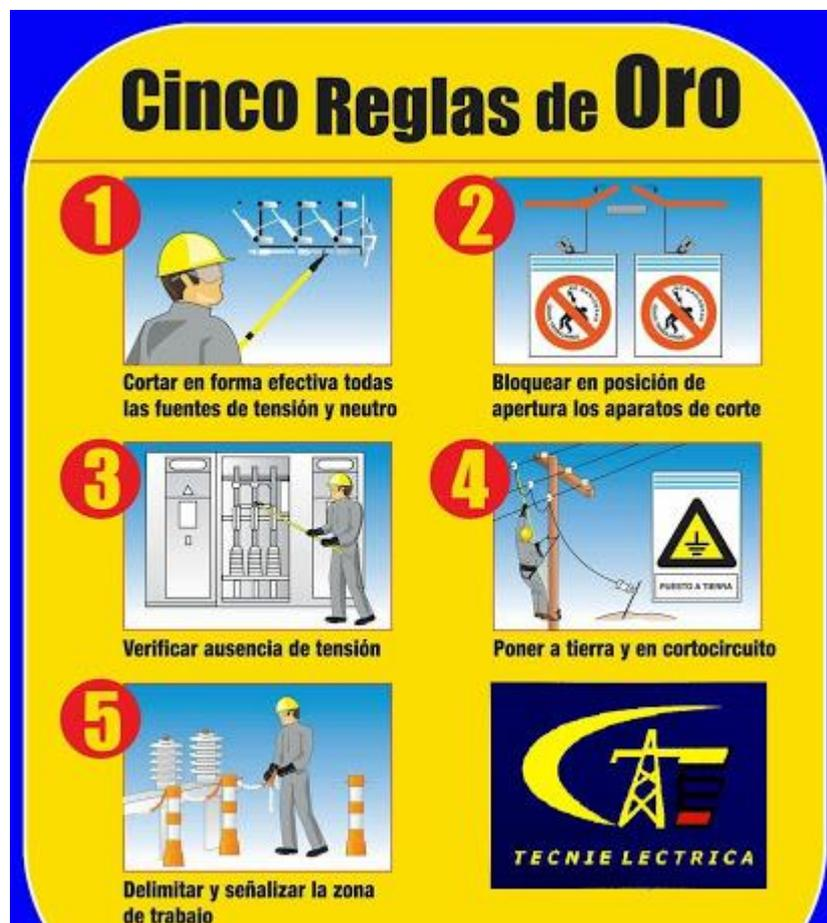
Figura 57. Cinco Reglas de Oro del mantenimiento eléctrico
