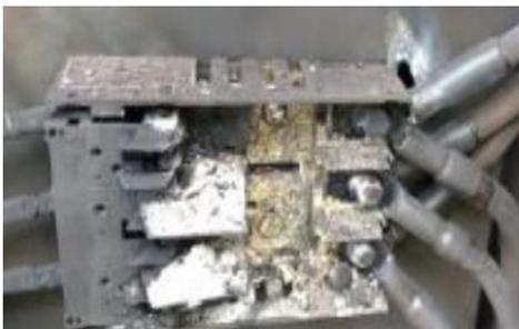
**Figura 51.** Contactos sulfatados
