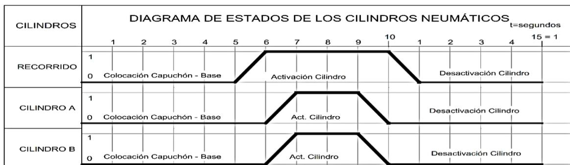
Figura 4.45: Diagrama de tiempo de los cilindros neumáticos de Recorrido, A y B.
