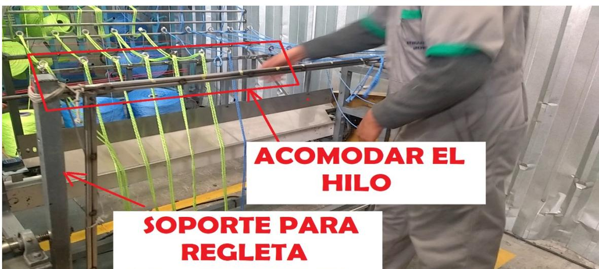
Figura 4.2: Ajuste del cabo del hilo provenientes de los carretes.
