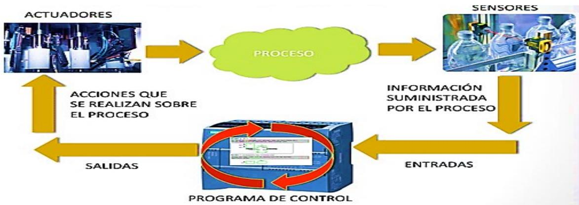
Figura 2.18: Proceso controlado por un PLC. [18]
