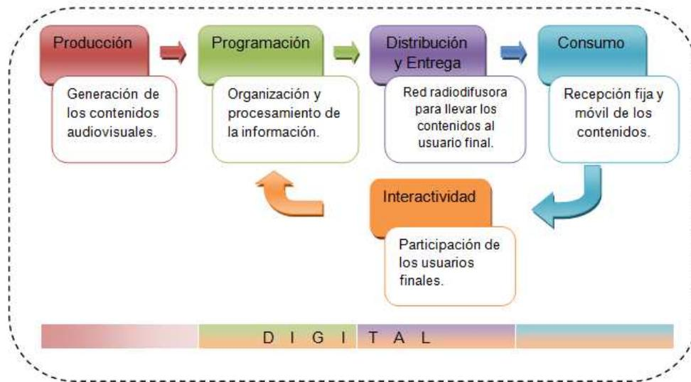
Figura 1.3 Sistema de Televisión Digital Terrestre
