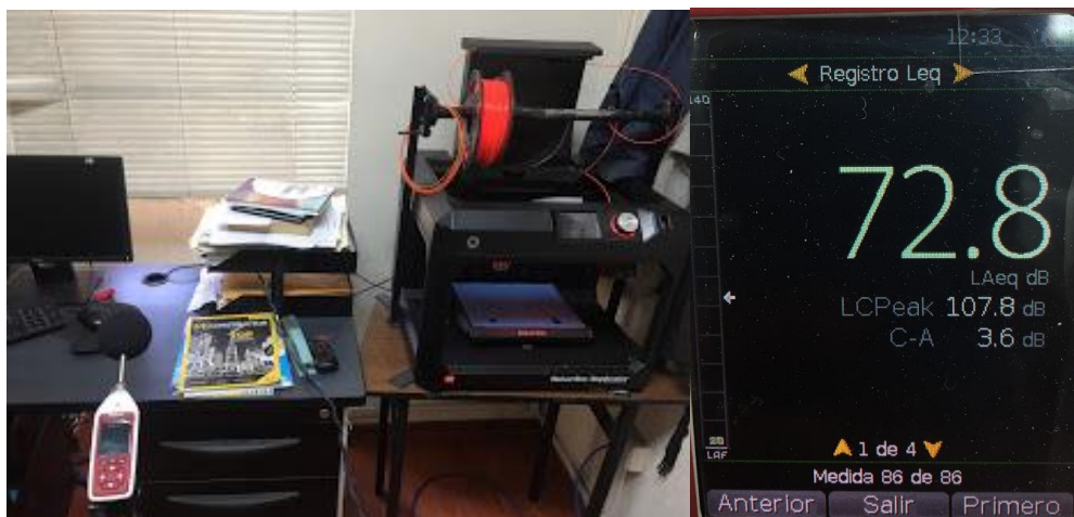
Figura 3.18. Medición de ruido en el área de diseño con la puerta cerrada
