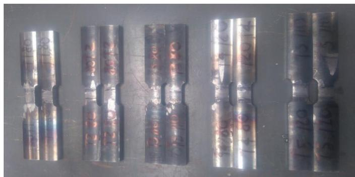
Figura 2.14 Probetas de tracción.
