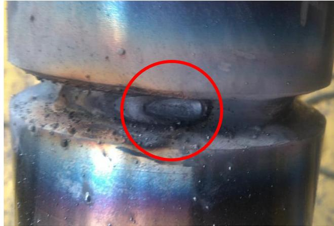
Figura 3.5 Fisura en el primer pase de la junta 4.
