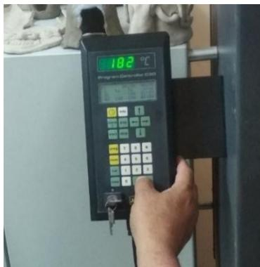
Figura 2.9 Programación de la temperatura del horno
