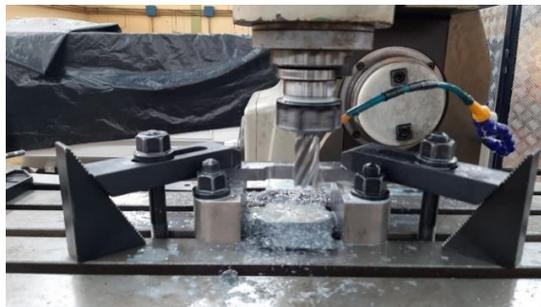
Figura 2.13 Maquinado de probetas para ensayos mecánicos.
