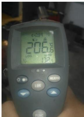
Figura 2.6 Medición de la temperatura entre pases.
