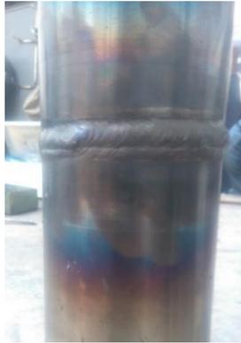
Figura 2.8 Cordón de soldadura acero AISI 4140
