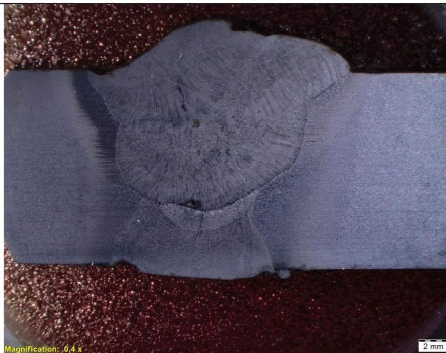
En esta macrografía se observa la falta de fusión entre el material base y el cordón del primer pase, además de la incompatibilidad del primer pase y los pases de relleno. Existe una gran formación de dendritas en los últimos pases. La ZAC tiene grano fino y el grano fino recristalizado en el metal soldado.
