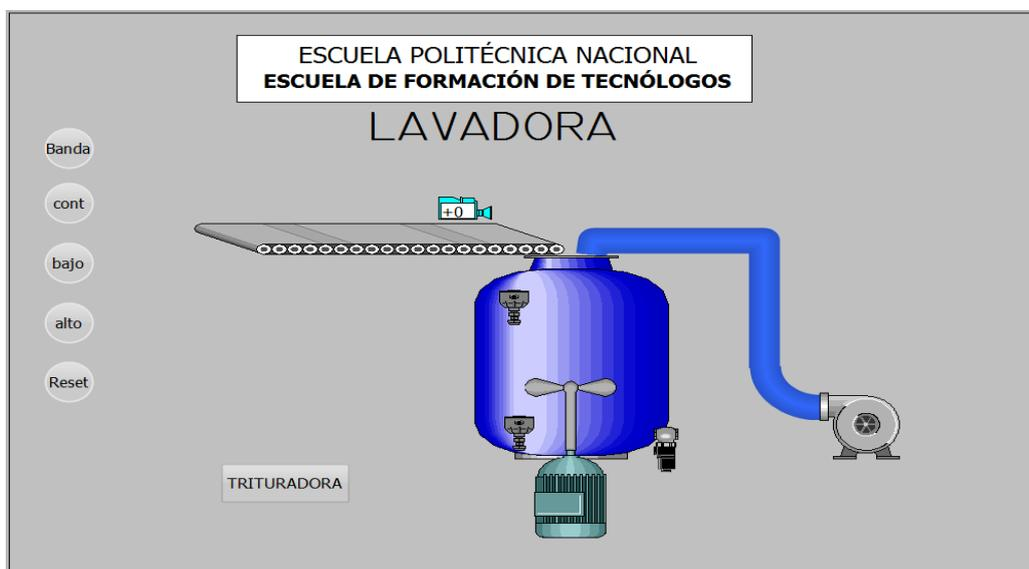
*Figura 3.41 Proceso transporte y lavado de botellas*
