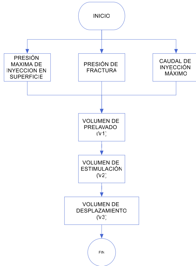
Figura 16: Proceso de la interfaz de Matlab para cálculo de volúmenes.
