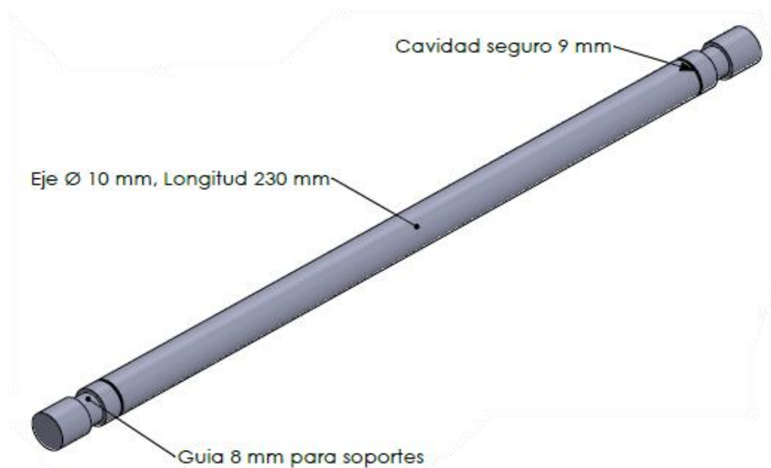
Figura 3.25: Vista isométrica del eje para el rodillo cortador.
