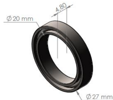
Figura 3.34: Vista isométrica de rodamiento 0200-27. Fuente: Propia
