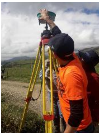
Fotografía 15 Receptor (izquierda) y Antena (derecha) SOKKIA usada para el levantamiento
