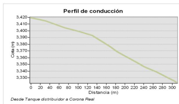
Figura 3.8 Línea de conducción del Barrio Corona Real
