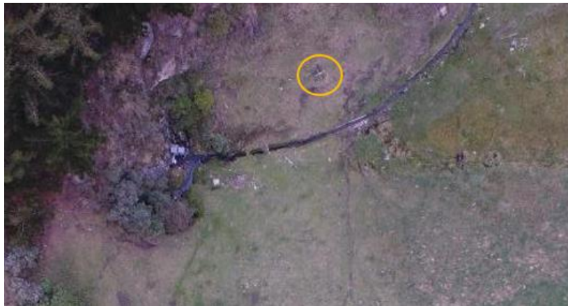
Figura 3.13 Marca para georreferenciación de la fotogrametría por dron
