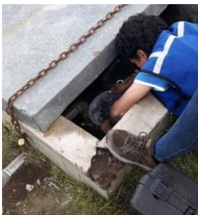
Fotografía 9 Obtención del aforo en el tanque rompe presiones mediante el método volumétrico
