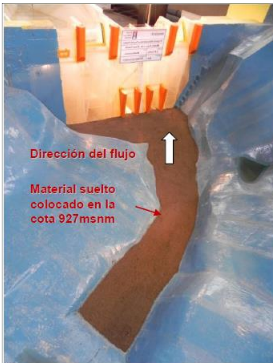
Figura 3-21 Vista de material suelto colocado antes del lavado
