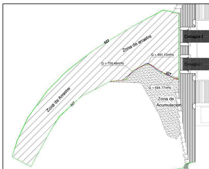
Figura 3-25 Pruebas Desagüe Derecho + Izquierdo Modelo Físico
