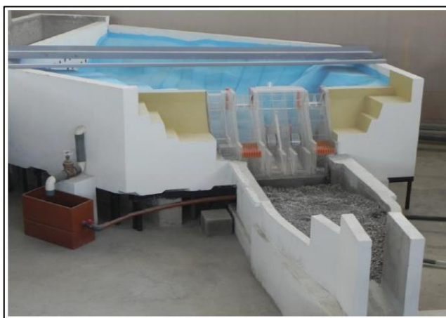
Figura 3-9 Modelo físico-presa Toachi
