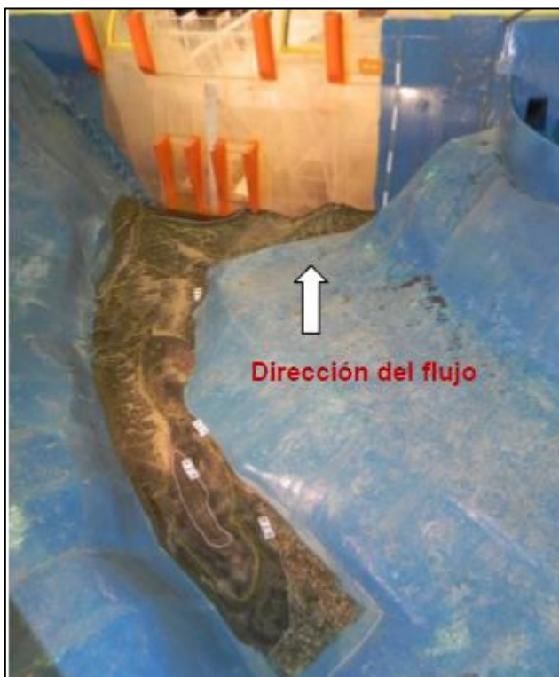
Figura 3-22 Vista de material suelto colocado posterior al lavado
