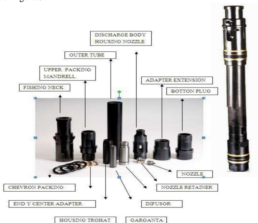
Figura 3. Partes de la bomba hidráulica tipo jet.
