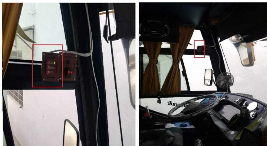
Figura 4.18. Ubicación del módulo control electrónico
