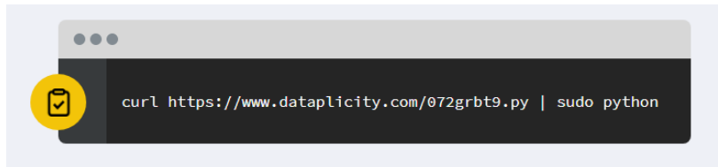
Figura 3.23. Comando para instalar Dataplicity en RPi
