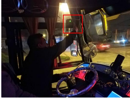
Figura 4.19. Prueba remota módulo de control electrónico
