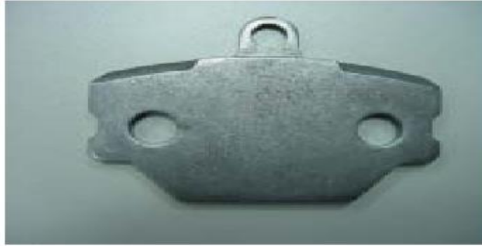
Figura 1.20. Soporte de acero para pastillas de freno (Bugaleta, 2016, p. 1)
