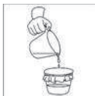
Figura 3- 32: Filtración de agua turbia
