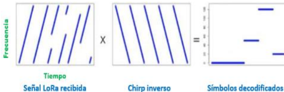
Figura 12. Demodulación de una señal LoRa
