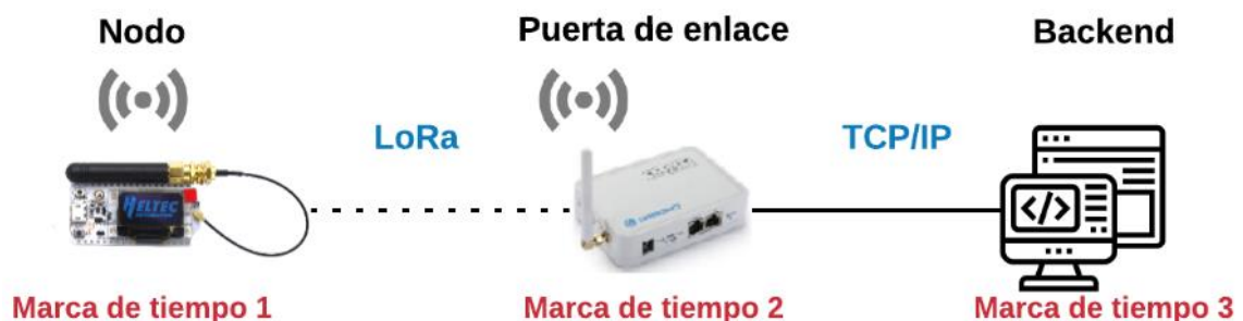
Figura 116. Elementos que conforman los puntos extremos del tramo LoRa y TCP/IP
