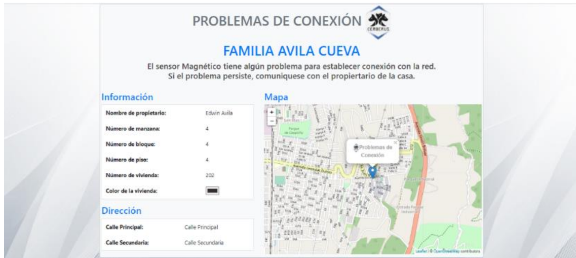
Figura 70. Información presentada en la aplicación web al recibir una alerta de desconexión de un nodo
