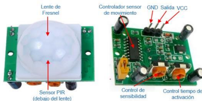
Figura 17. Elementos que conforman al sensor de movimiento PIR HC-SR501
