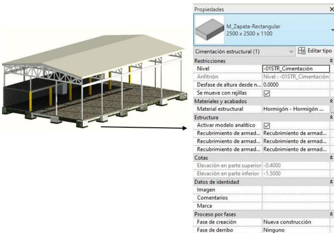
**Figura 2.2.** Propiedades de un elemento estructural
