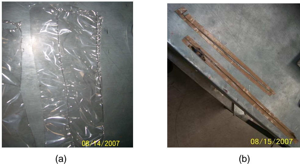
Figura 2.15 Prueba 2 (a) t=2 seg calentamiento, plástico sellado y cortado, (b) t=2 seg, teflón quemado por falta de enfriamiento
