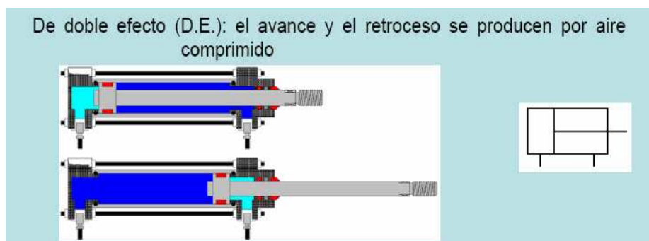
Figura 1.34 Cilindro de Doble Efecto
