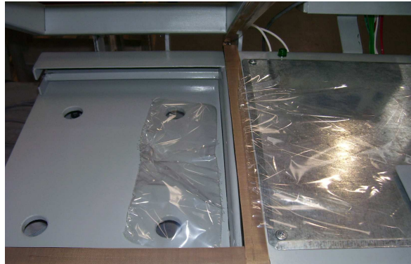
Figura 2.16 Prueba 3 : t_1= 1 seg retardo, t_2= 2 seg calentamiento, t_3= 1 seg enfriamiento, plástico sellado y cortado con teflón intacto.
