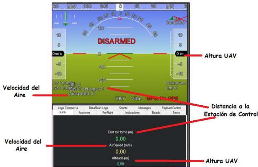
Figura 2.13. Datos de Telemetría en las Pantallas de Mission Planner
