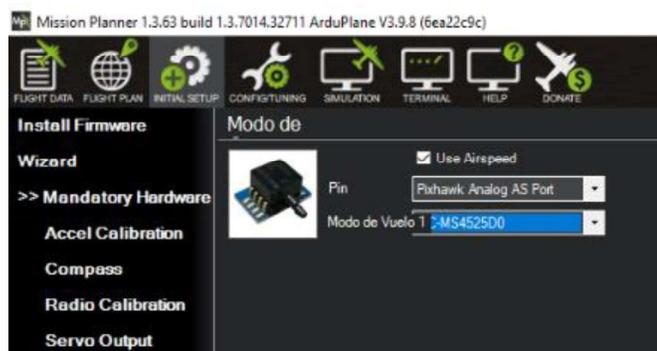
Figura 2.9. Configuración Sensor de Velocidad
