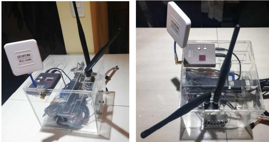
Figura 2.21. Ubicación Física de los equipos en la caja de la estación de control
