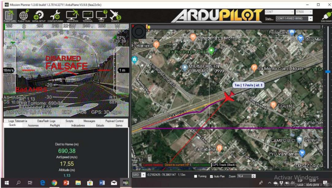
Figura 3.4. Prueba del enlace de telemetría a una distancia de 690,38 m (Fuente: Propia)
