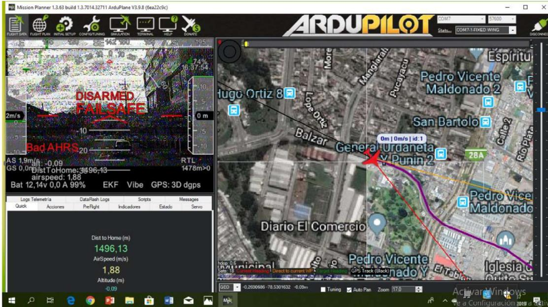
Figura 3.11. Prueba del enlace de telemetría a una distancia de 1496,13 m (Fuente: Propia)
