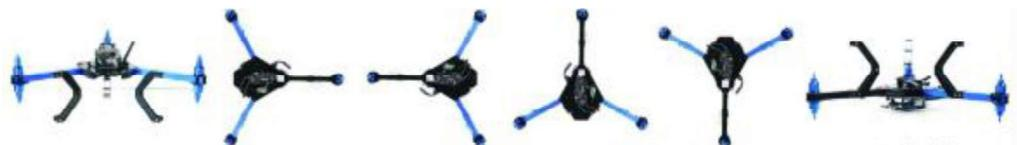
Figura 2.6. Calibración Acelerómetro
