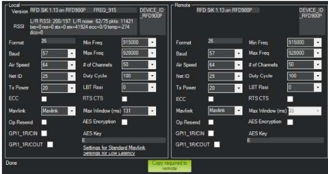
Figura 2.11. Valores configurados en el modem RFD900+
