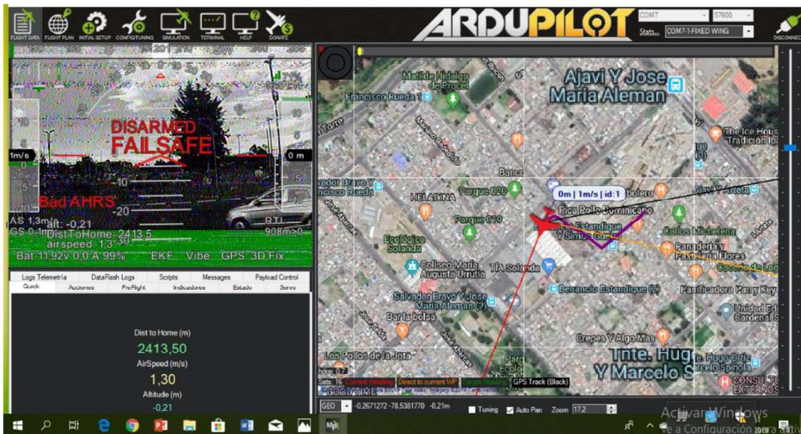
Figura 3.12. Prueba del enlace de telemetría a una distancia de 2413,5 m (Fuente: Propia)
