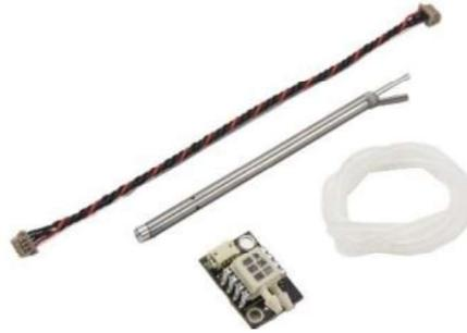
Figura 1.26. Sensor de Velocidad de Aire MS4525DO
