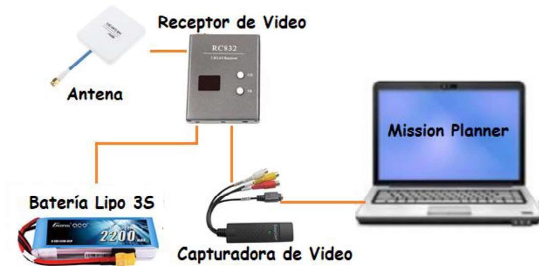
Figura 2.16. Conexión de equipos a la Estación de Control
