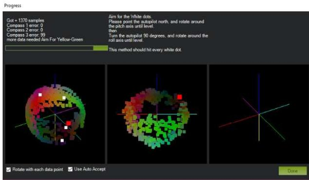
Figura 2.7. Calibración de la brújula
