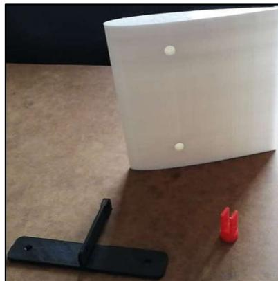
**Figura 2.12.** Perfil NACA 0012 y acoples construidos.
