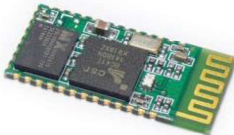
Figura 2.19. Módulo Bluetooth HC-05. Funciona como emisor y receptor. Se comunica directamente con el Bluetooth de la PC
