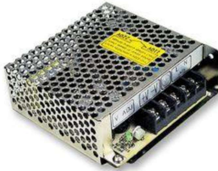
Figura 2.18. Fuente de Alimentación de los Controladores. Entrada de 120V de corriente alterna. Salida de 12V de corriente continua, 5A.
