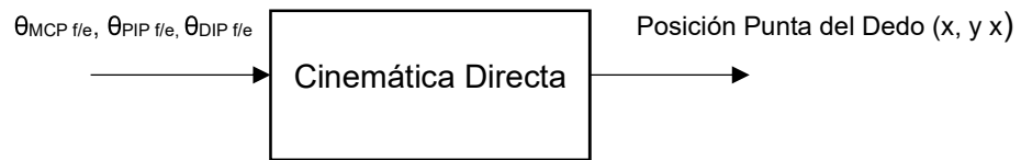
Figura 1.13. Diagrama de bloques de la cinemática directa (Fuente: propia)
