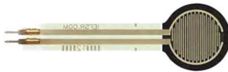
Figura 2.11. Sensor de fuerza resistivo. FSR 402. La parte circular es donde se aplica la fuerza. En la parte izquierda se tiene la conexión eléctrica.
