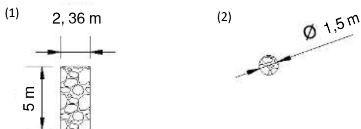
Figura 27. Esquema de propuesta de diseño de sistema de adsorción de lecho fijo. Fuente: (Al-Haj-Ali & Al-Hunaidi, 2004)
