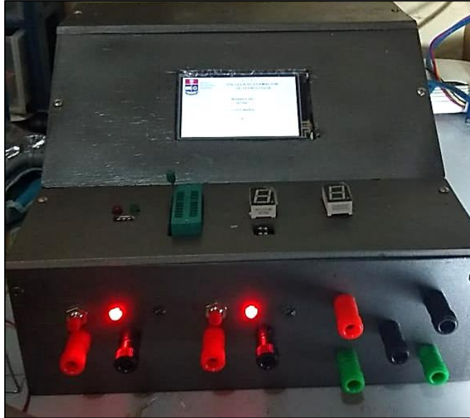
Figura 3.63: Encendido y acceso al módulo entrenador lógico.
