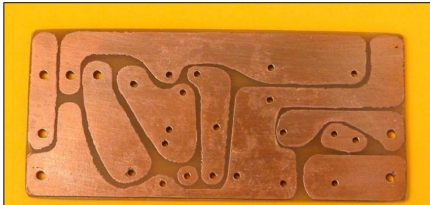
Figura 1.8: Resultado de la perforación de una placa PCB [26].
