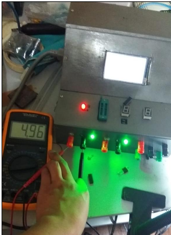
Figura 3.71: Prueba Fuente de 5 voltios N.º 1.
