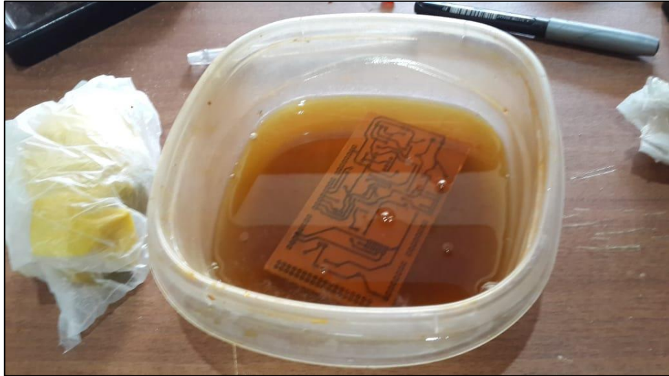
Figura 3.29: Ataque químico de la baquelita en ácido férrico.
