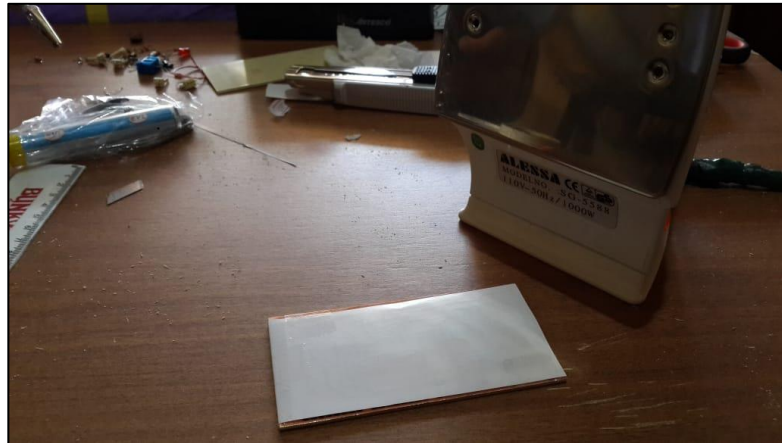
Figura 3.27: Transferencia del diseño en la baquelita.
