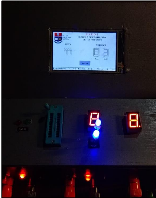
Figura 3.66: Prueba comprobador de displays y diodos LED.
