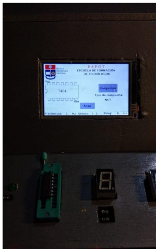
Figura 3.65: Prueba comprobador de compuertas lógicas.
