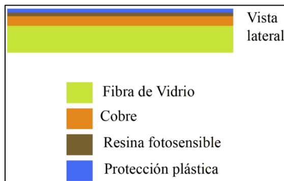
Figura 1.6: Capas de una placa para circuito impreso [24].
