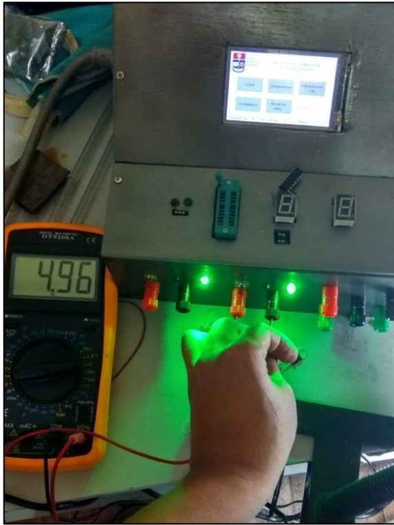
Figura 3.72: Prueba Fuente de 5 voltios N.º 2.
