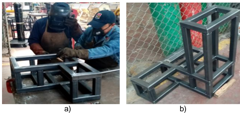
Figura 2.62: a) Proceso de soldadura, b) estructura de acero terminada. (Fuente: Propia)
