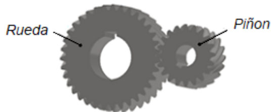
Figura 2.9: Sistema de transmisión por engranajes helicoidales. (Fuente: Propia)
