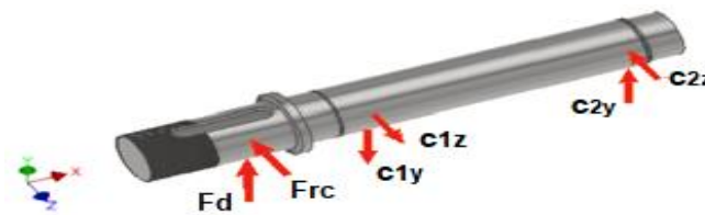
Figura 2.22: Diagrama de cuerpo libre del eje C. (Fuente: Propia)
