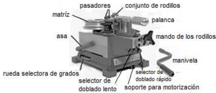
Figura 1.4: Dobladora de tubos manual. (Fuente: Swagelok, 2016)
