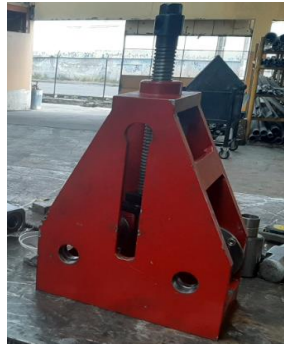
Figura 2.4: Estructura existente de una roladora con ejes de posición horizontal. (Fuente: Propia)
