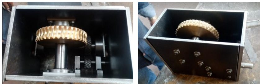
Figura 2.64: Caja reductora de velocidad armada. (Fuente: Propia)
