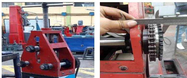
Figura 2.65: Ensamble de ejes motrices y piñones. (Fuente: Propia)
