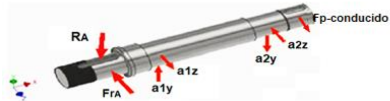
Figura 2.13: Diagrama de cuerpo libre del eje A. (Fuente: Propia)
