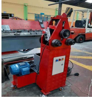
Figura 2.66: Partes de la roladora fijadas en la estructura de acero. (Fuente: Propia)
