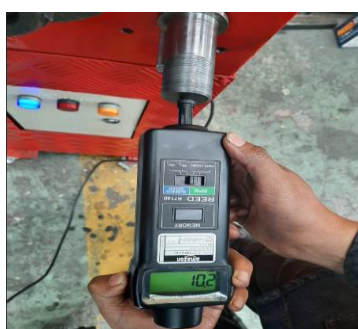
Figura 3.2: Medición de la velocidad de giro del eje inferior. (Fuente: Propia)
