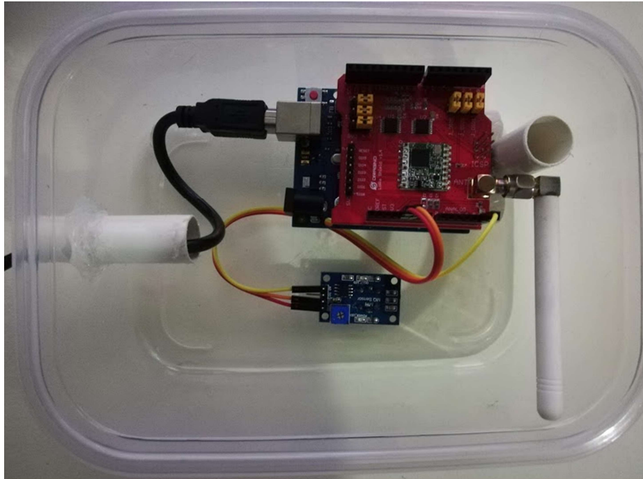
Figura 2.9.- Vista superior del sensor, LoRa Shield, Arduino, interior del envase plástico
