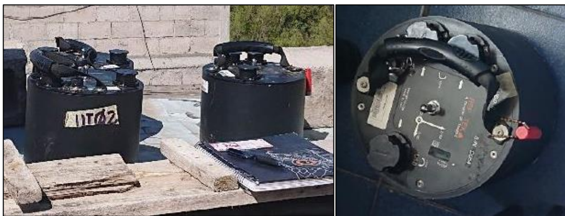
Figura 68. Acelerómetro marca Trimble
