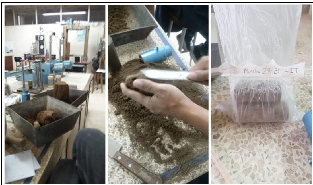
Figura 65. Tallado de muestras previo al ensayo de Triaxial.
