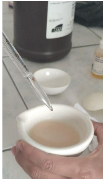
FIGURA 3-12. PRUEBA DE TITULACIÓN DE CLORUROS
