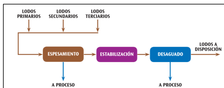
Figura 3 Esquema general de un sistema de tratamiento de lodos
