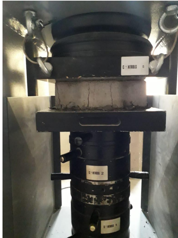
Figura 26 Equipo de compresión
