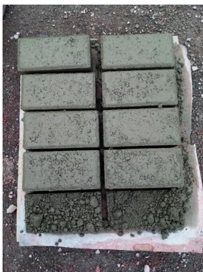
Figura 36 Daños en la estructura del adoquín en fase de fabricación
