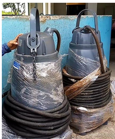
Figura 5 Bombas sumergibles de impulsión
