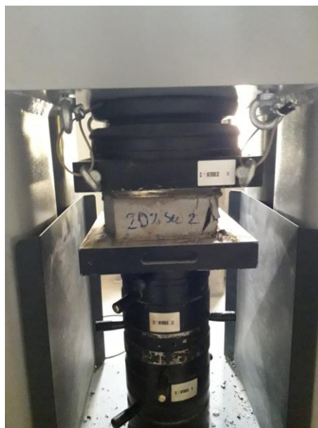
Figura 27 Ensayo de compresión, visualización de la ruptura del elemento
