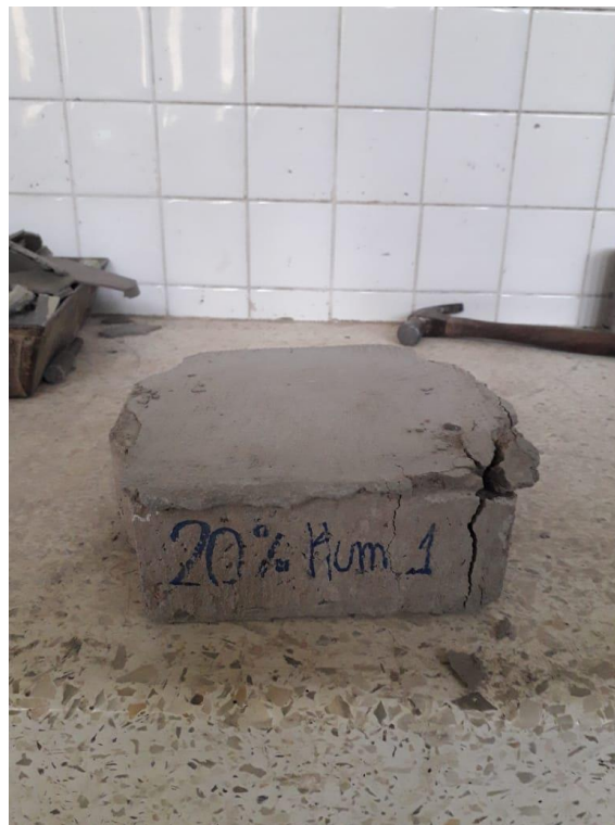
Figura 25 capa de cemento para igualar imperfecciones del adoquín
