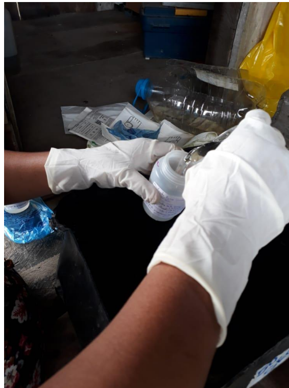
Figura 29 Toma de muestras de lixiviados
