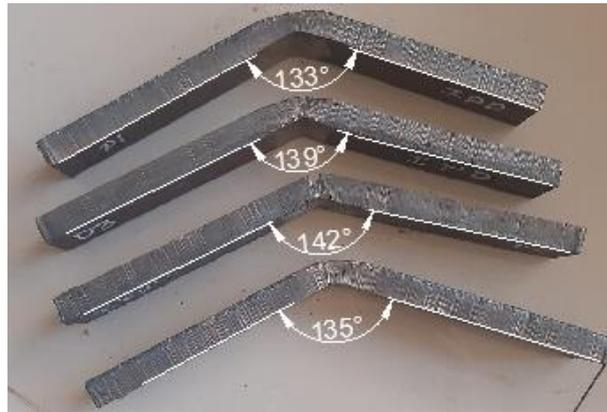
Figura 3.16. Probetas con IPDs doblada
