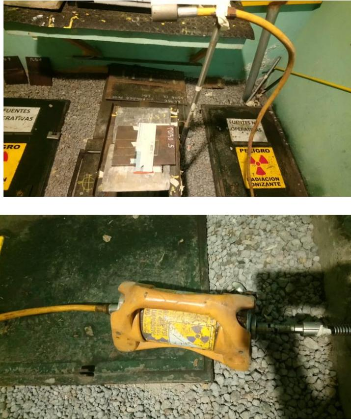
Figura 2.4. Equipo de Gammagrafía
