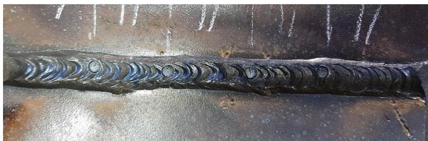
Figura 2.13. Cordón de soldadura con esferas insertadas
