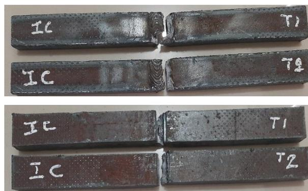
Figura 3.7. Probetas con IC fracturadas por tracción
