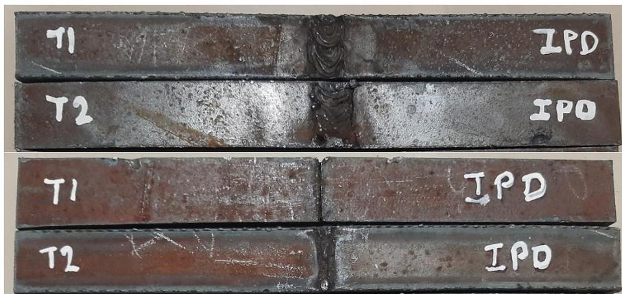
Figura 2.17. Probeta con concavidad interna por desalineación
