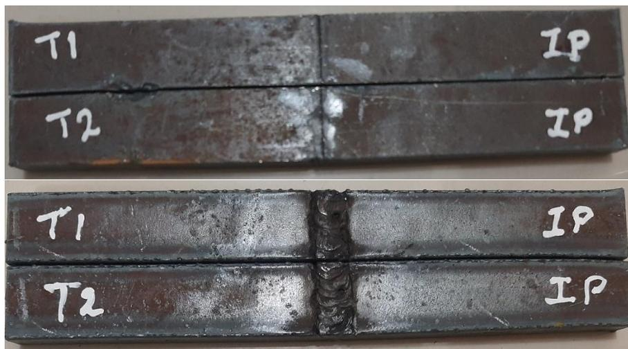
Figura 2.1512. Probetas con penetración incompleta
