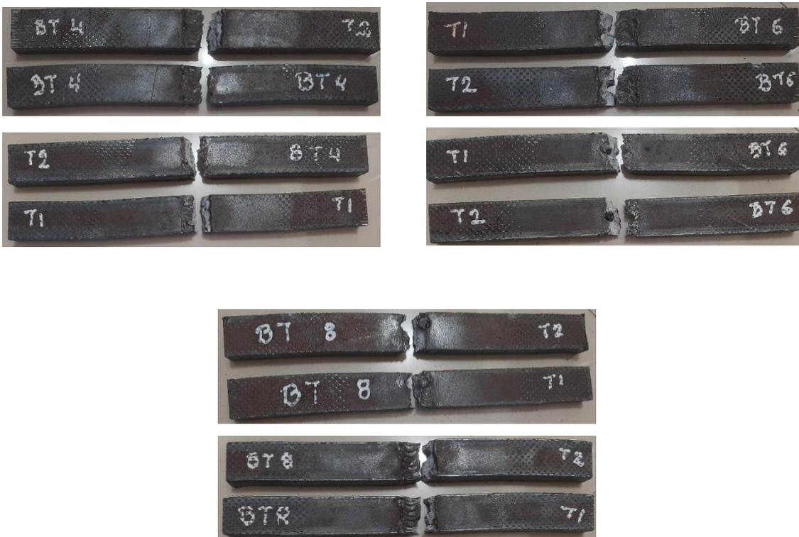
Figura 3.9. Probetas con BT fracturadas por tracción
