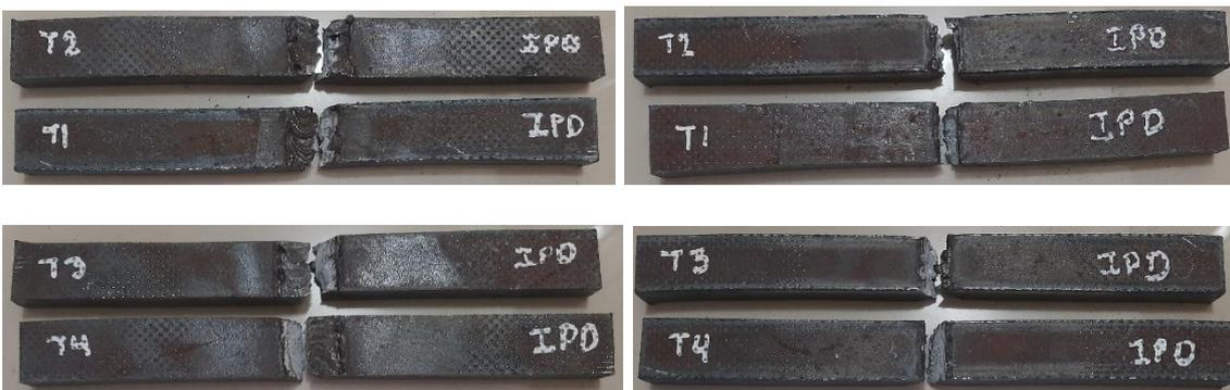
Figura 3.5. Probetas con IPDs fracturadas por tracción
