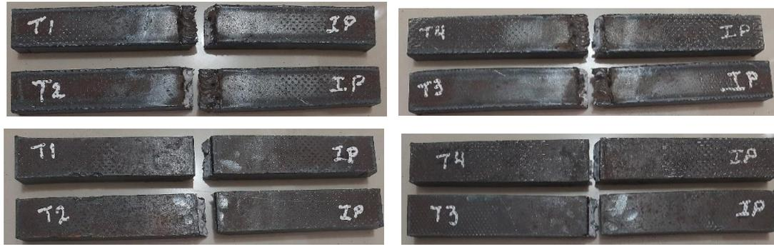
Figura 3.3. Probetas con penetración incompleta fracturadas después de ensayo a tracción
