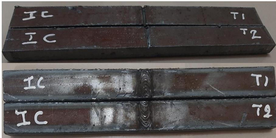
Figura 2.16. Probeta con concavidad interna
