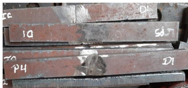
Figura 2.143. Probetas mecanizadas para el ensayo de doblado
