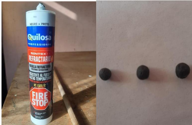
Figura 2.12. Esferas de sintex refractario
