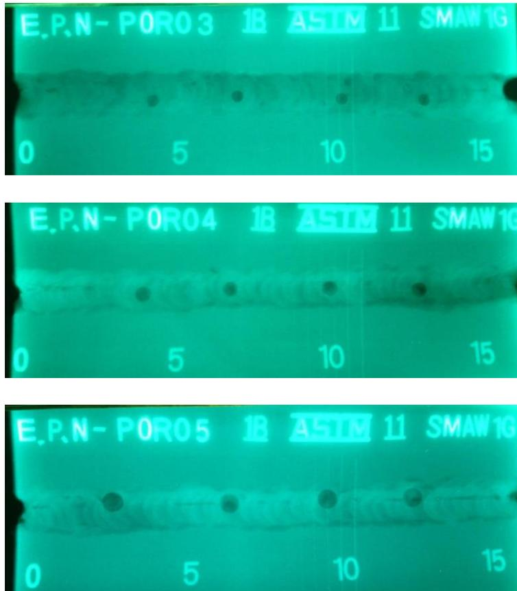
Figura 2.14. Radiografía de cordón de soldadura con poro de 3,4 y 5 mm
