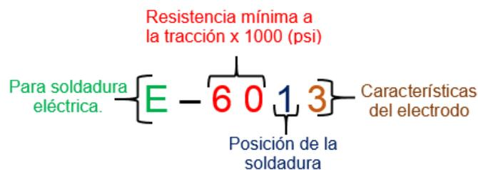
Figura 1.9. Identificación de los electrodos
