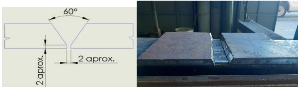
Figura 2.8. Dimensionamiento del bisel
