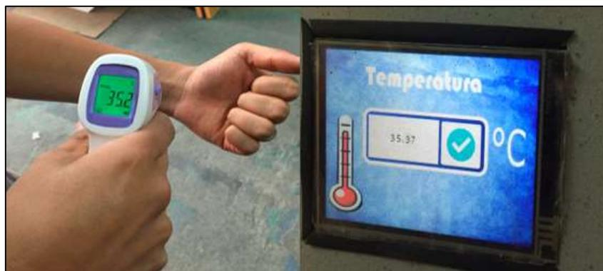
Figura 3.90: Calibración del sensor MLX90614
