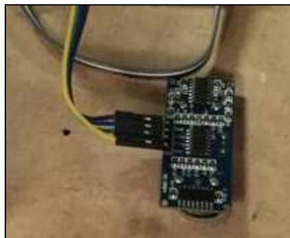
Figura 3.79: Instalación sensor ultrasónico
