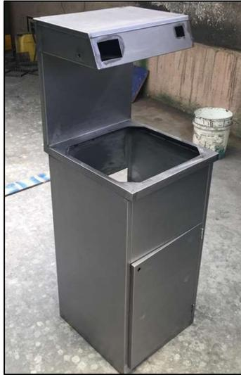
Figura 3.78: Estructura metálica del lavamanos
