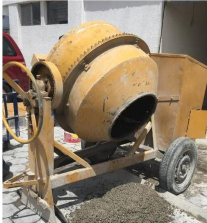
*Figura 3.8: Concretera de 1m<sup>3</sup> de capacidad.*
