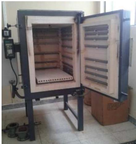
*Figura 3.5: Horno utilizado para la afectación térmica de cubos de mortero.*
