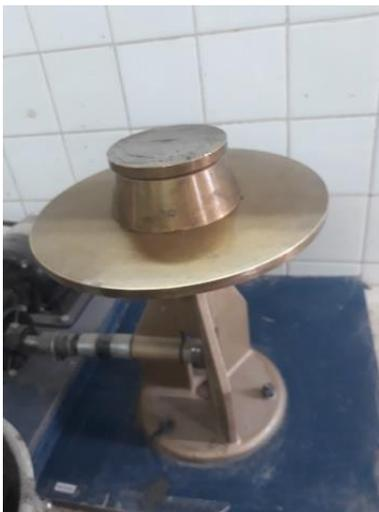
*Figura 4.8. Mortero en molde de flujo.*
