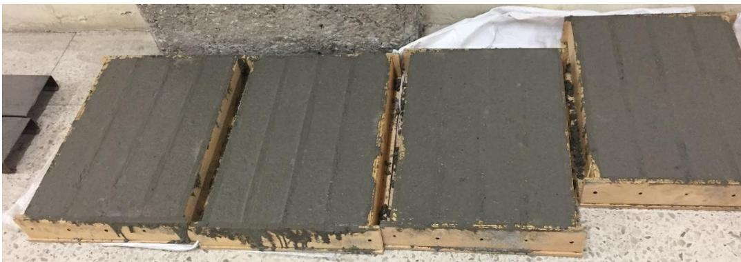
*Figura 4.32 Fraguado de vigas.*
