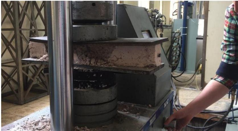
*Figura 4.35 Rotura de vigas.*
