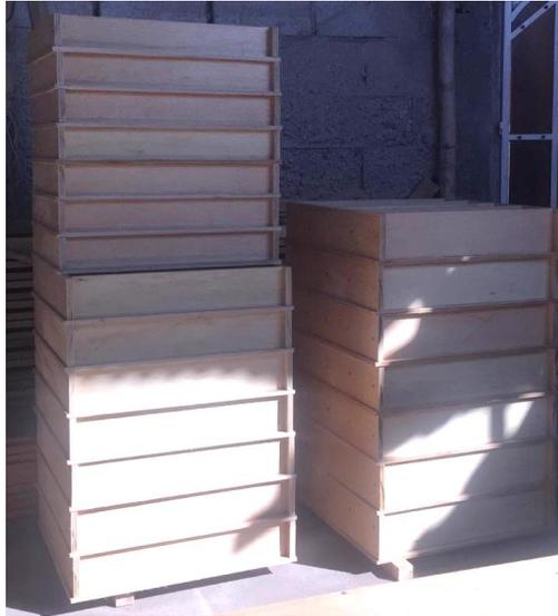
*Figura 4.19 Prototipo de Encofrados de Vigas.*
