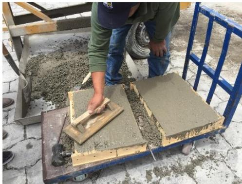
*Figura 4.31 Enrazado de vigas.*
