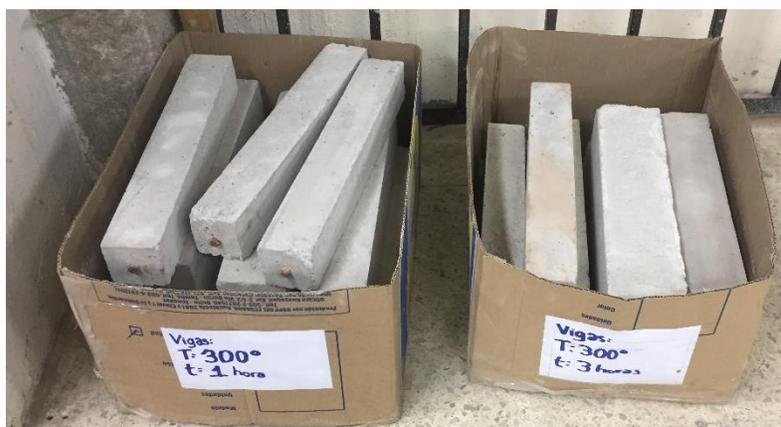
Figura 4.34 Vigas calentadas.
