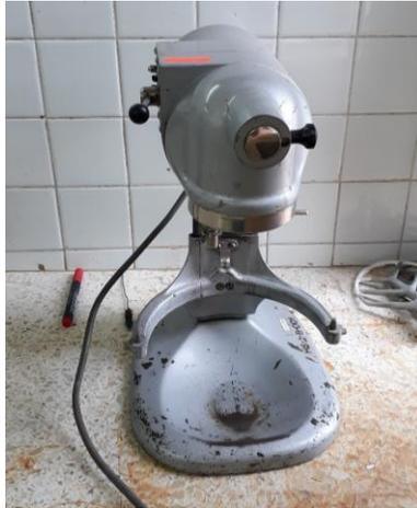
*Figura 3.2.: Mezcladora mecánica planetaria.*
