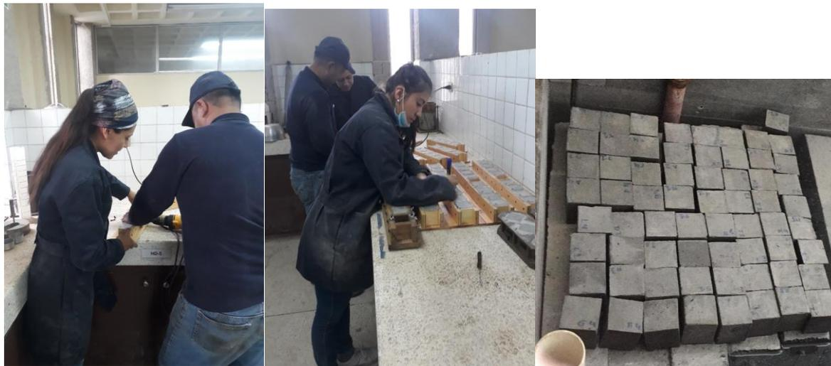
*Figura 4.14 Desencofrado, etiquetado y curado de cubos.*
