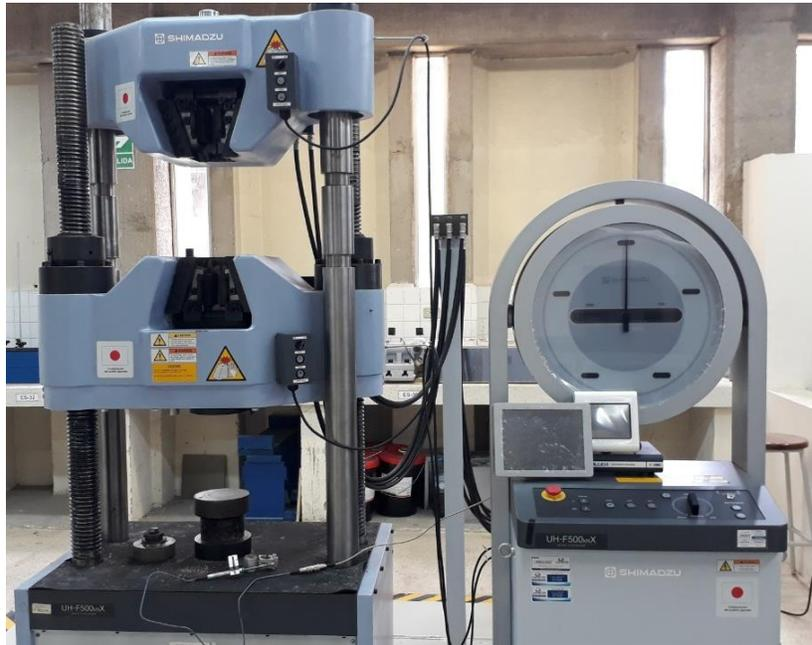
*Figura 3.11: Marco de prueba hidráulico universal.*
