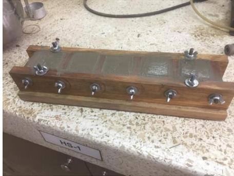
*Figura 3.4: Encofrado de Cubos.*
