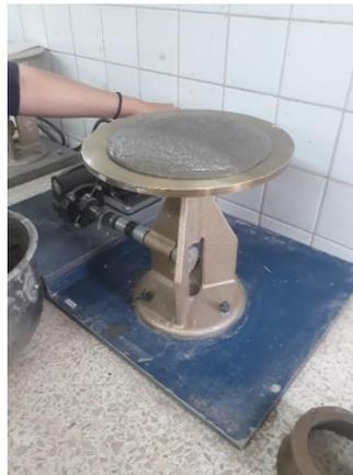
Figura 4.10 Diámetro de ensayo de flujo.
