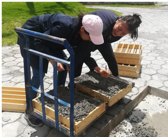
Figura 4.29 Preparación de vigas.
