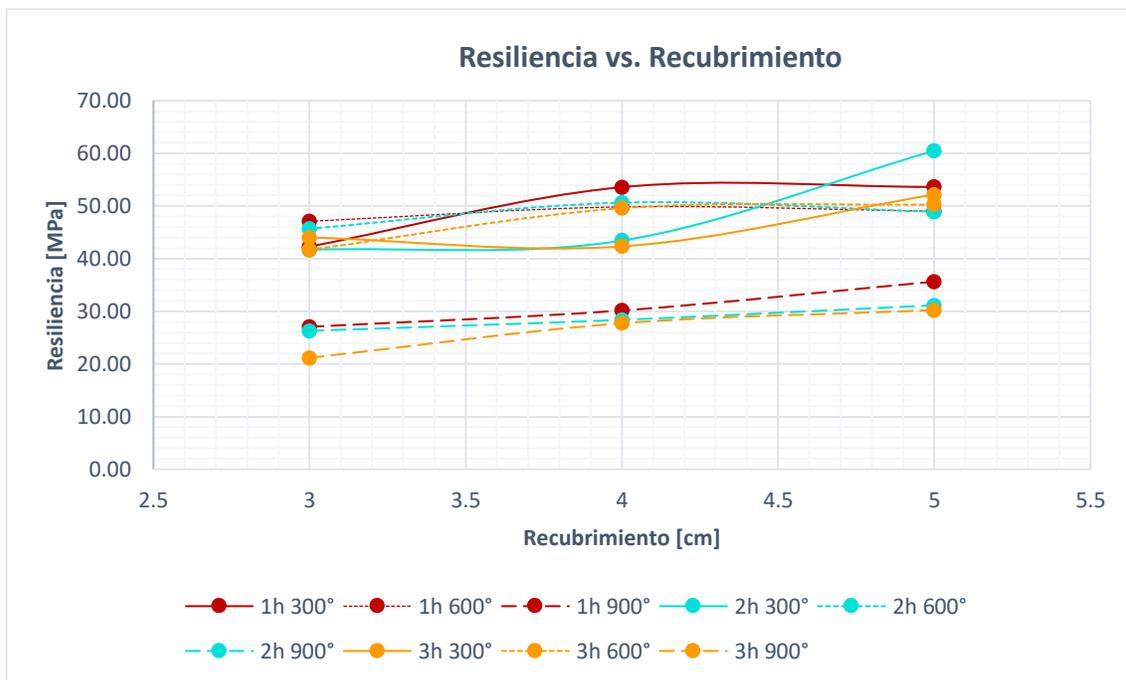
Figura 5.28 Resiliencia [MPa] Vs. Recubrimiento [cm].
