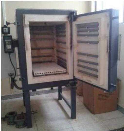
*Figura 3.9: Horno Nabertherm empleado para la afectación térmica de vigas de hormigón armado.*
