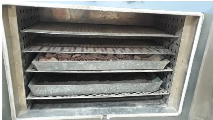
*Figura 4.20.: Secado de Agregados.*
