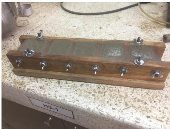
*Figura 4.1: Prototipo de Encofrados de Cubos.*
