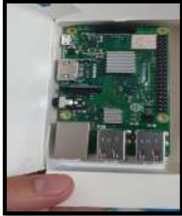
Figura 3.38: Implementación de disipadores
