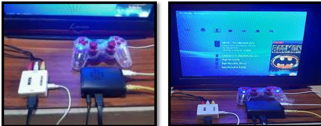
Figura 3.152: Prueba de visualización mediante salida RCA
