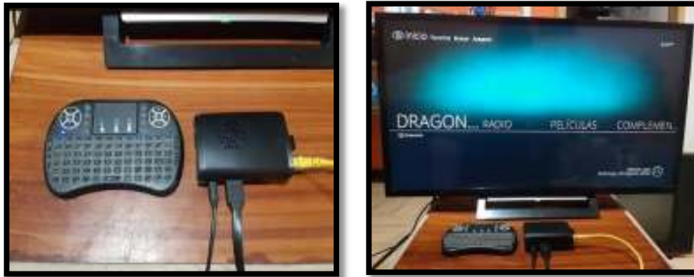
Figura 3.151: Prueba de visualización mediante salida HDMI
