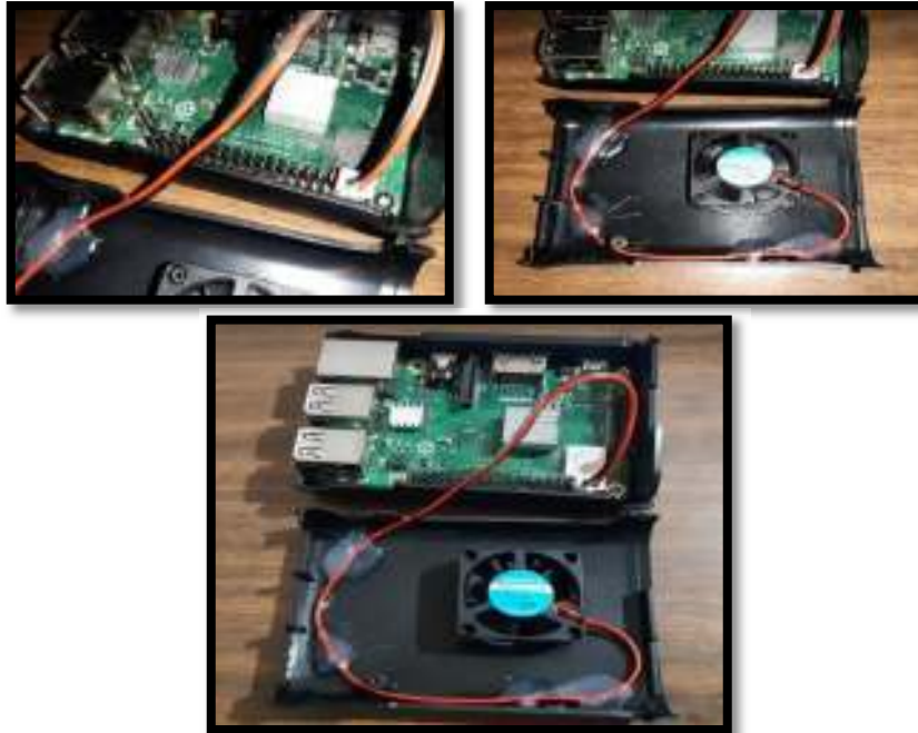
Figura 3.40: Implementación del mini ventilador
