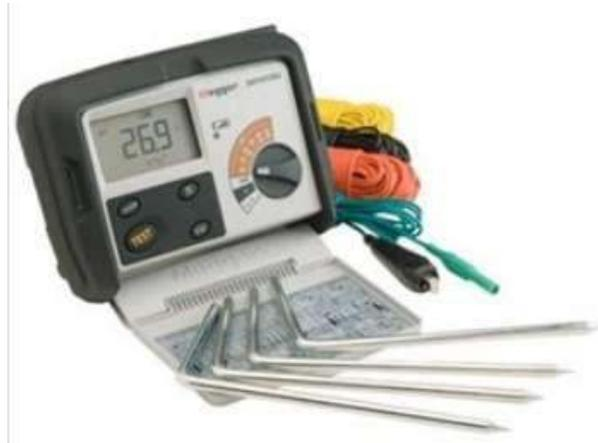
**Figura 1-7** Telurómetro Megger DET4TCR2 (AMAZON, 2019)
