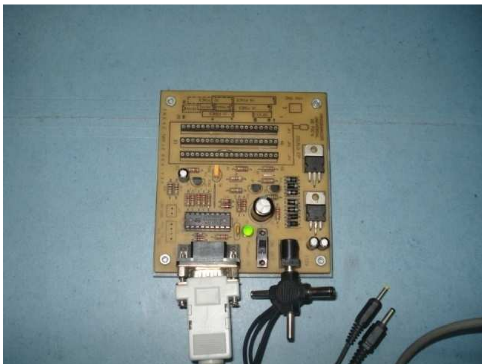
Figura 2.16 Hardware que permite la grabación del programa en el micro. Prg.INE4C
