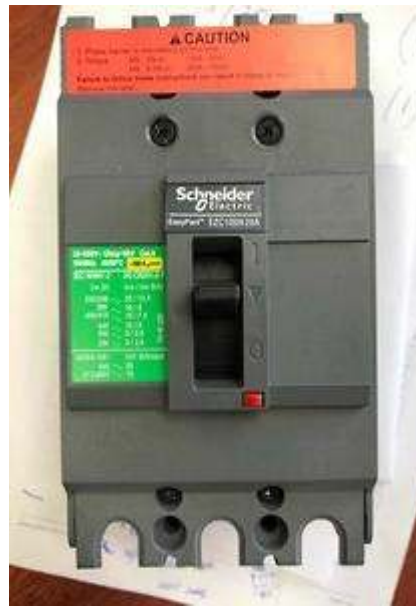
Figura 3.5 Disyuntor de 40 (A) trifásico.
