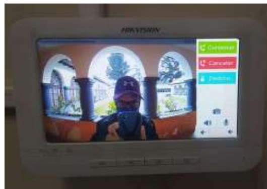
Figura 3.51 Recepción de llamada desde la estación interior
