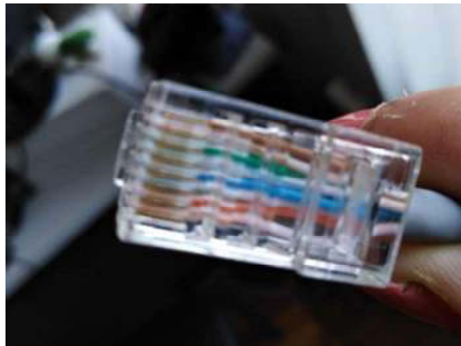
Figura 3.14 Ponchado de cables Ethernet
