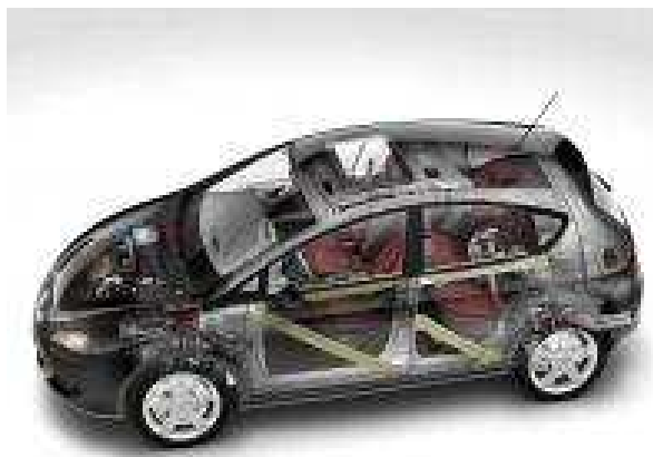
Figura 2.5 Estructura interna de la carrocería.
