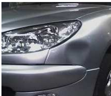
Figura 4.35. Abolladura en un guardabarros.
