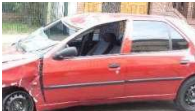
Figura 4.9. Golpe graves recibido en las láminas de la carrocería.
