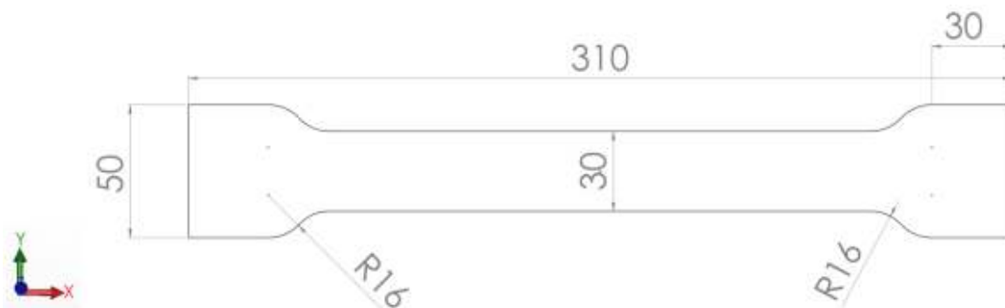
Figura 2.5. Geometría final de probeta de PS de 0,7mm de espesor utilizada en la máquina universal de ensayos para realizar un ensayo de Relajación de esfuerzos
