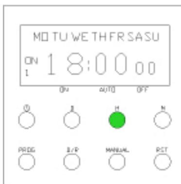
**Figura 6** Programación de la hora de activación del Relé.
