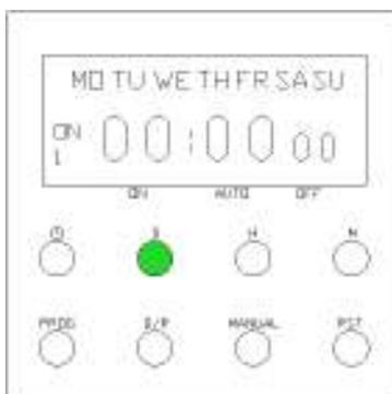
**Figura 5** Programación del día de activación del Relé.
