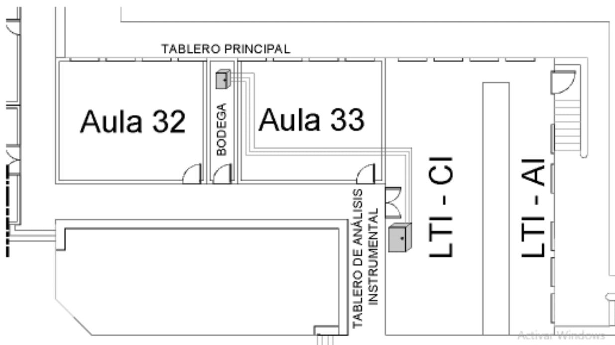
**Figura 3.5** Tendido de la acometida del tablero de control principal.
