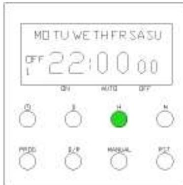
**Figura 10** Programación de la hora de desactivación del Relé.
