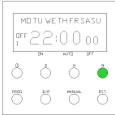
**Figura 11** Programación de los minutos de desactivación del Relé.
