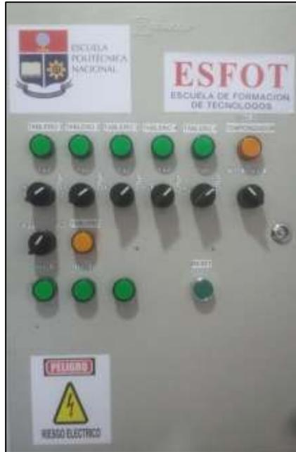
**Figura 3.15** Luces piloto y selectores montados y asegurados en el gabinete.
