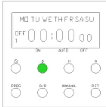
**Figura 9** Programación del día de desactivación del Relé.
