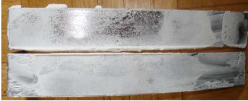
Fig. 7.24 Probeta C del ensayo de Pelado con la resina Marine Epoxy Probeta C: Presenta un fallo cohesivo.
