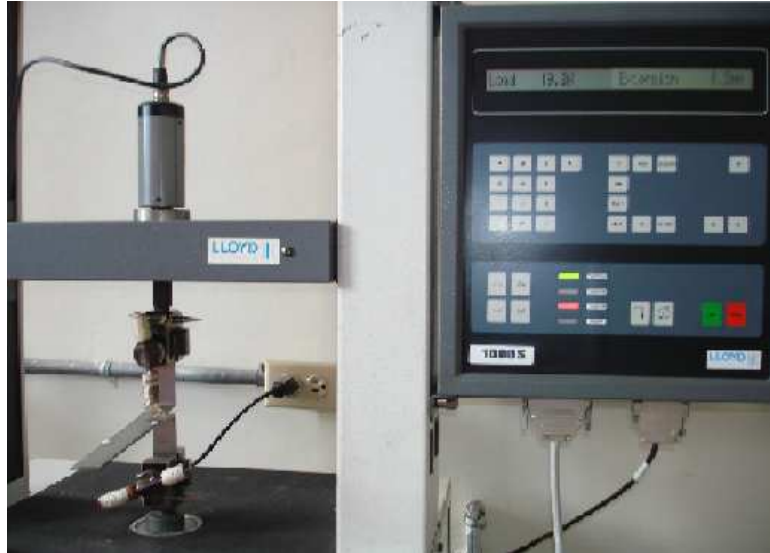
Fig 7.2 Máquina utilizada para el ensayo de tracción y pelado.
