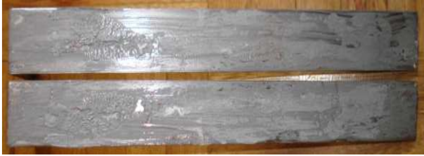
Fig. 7.12 Probeta C del ensayo de Pelado con la resina Poxy Bonder Probeta C: Presenta un fallo cohesivo
