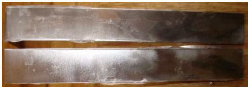
Fig. 7.28 Probeta A del ensayo de Pelado con la resina 2 Ton Epoxy
