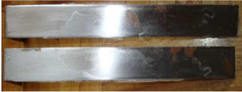
Fig. 7.6 Probeta C del ensayo de Pelado con la resina Perma Epoxy
