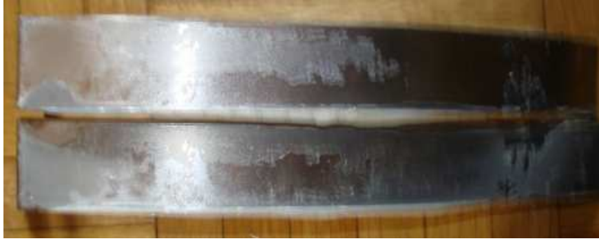
Fig. 7.18 Probeta C del ensayo de Pelado con la resina Super Epoxy Probeta C: Presenta un fallo adhesivo.
