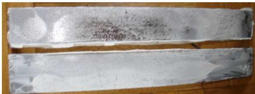
Fig. 7.23 Probeta B del ensayo de Pelado con la resina Marine Epoxy
