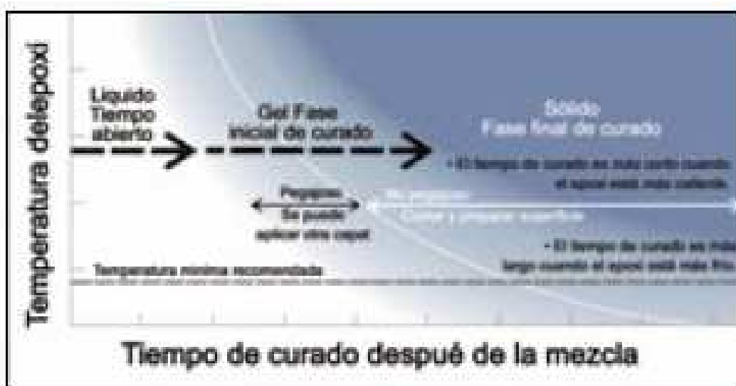
Fig. 4.8 Al curarse, el epoxi mezclado pasa de un estado líquido a través de un estado gelatinoso a un estado sólido 7 .
