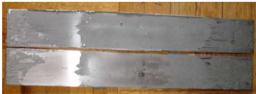
Fig. 7.10 Probeta A del ensayo de Pelado con la resina Poxo Bonder
