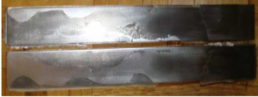
Fig. 7.30 Probeta C del ensayo de Pelado con la resina 2 Ton Epoxy Probeta C: Presenta un fallo cohesivo al 50%
