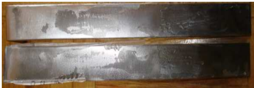
Fig. 7.29 Probeta B del ensayo de Pelado con la resina 2 Ton Epoxy
