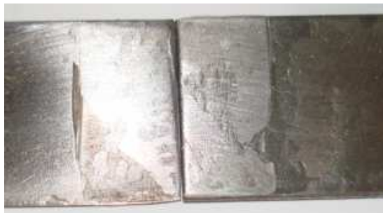
Fig. 7.3 Fallo del adhesivo Perma Epoxy
