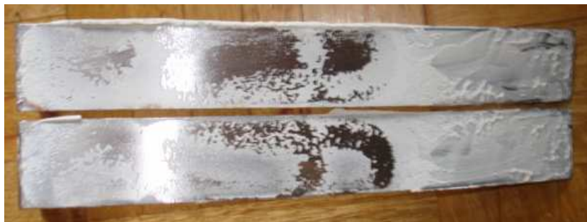
Fig. 7.22 Probeta A del ensayo de Pelado con la resina Marine Epoxy
