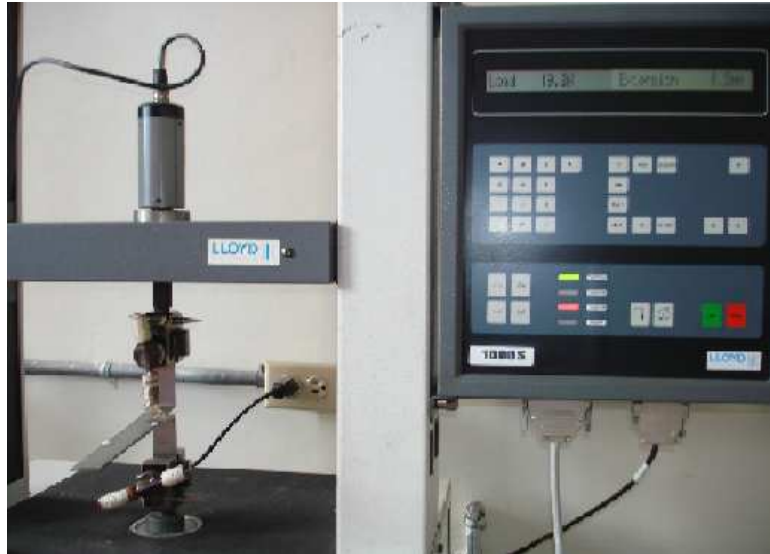
Fig 7.14 Maquina utilizada para el ensayo de tracción y pelado.
