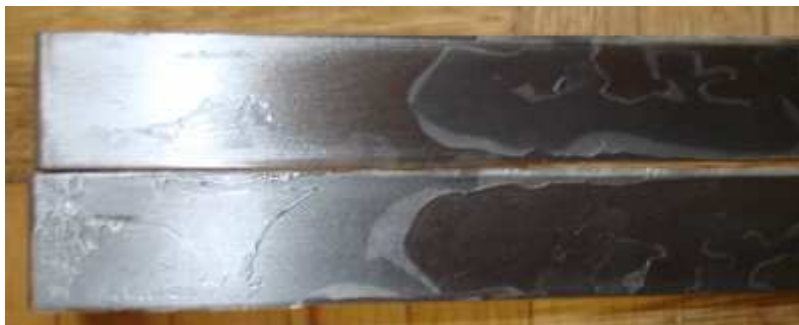
Fig. 7.4 Probeta A del ensayo de Pelado con la resina Perma Poxy
