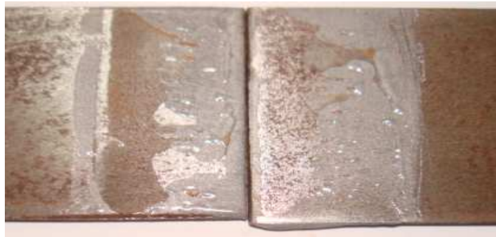
Fig. 7.9 Fallo del adhesivo Poxi Bonder
