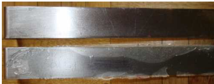
Fig. 7.5 Probeta B del ensayo de Pelado con la resina Perma Epoxy
