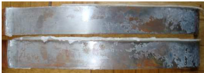
Fig. 7.16 Probeta A del ensayo de Pelado con la resina Super Epoxy
