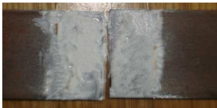
Fig. 7.21 Fallo del cohesivo Marine Epoxy
