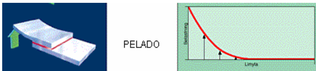
Fig.5.11 Esfuerzos de pelado 6 .
