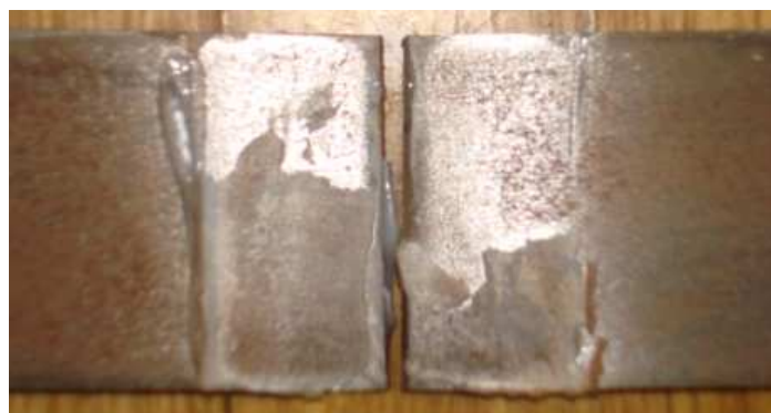
Fig. 7.15 Fallo del adhesivo Super Epoxy
