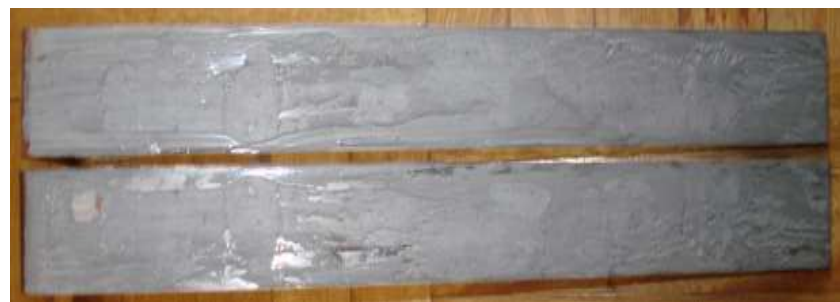
Fig. 7.11 Probeta B del ensayo de Pelado con la resina Poxo Bonder
