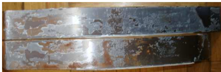
Fig. 7.17 Probeta B del ensayo de Pelado con la resina Super Epoxy
